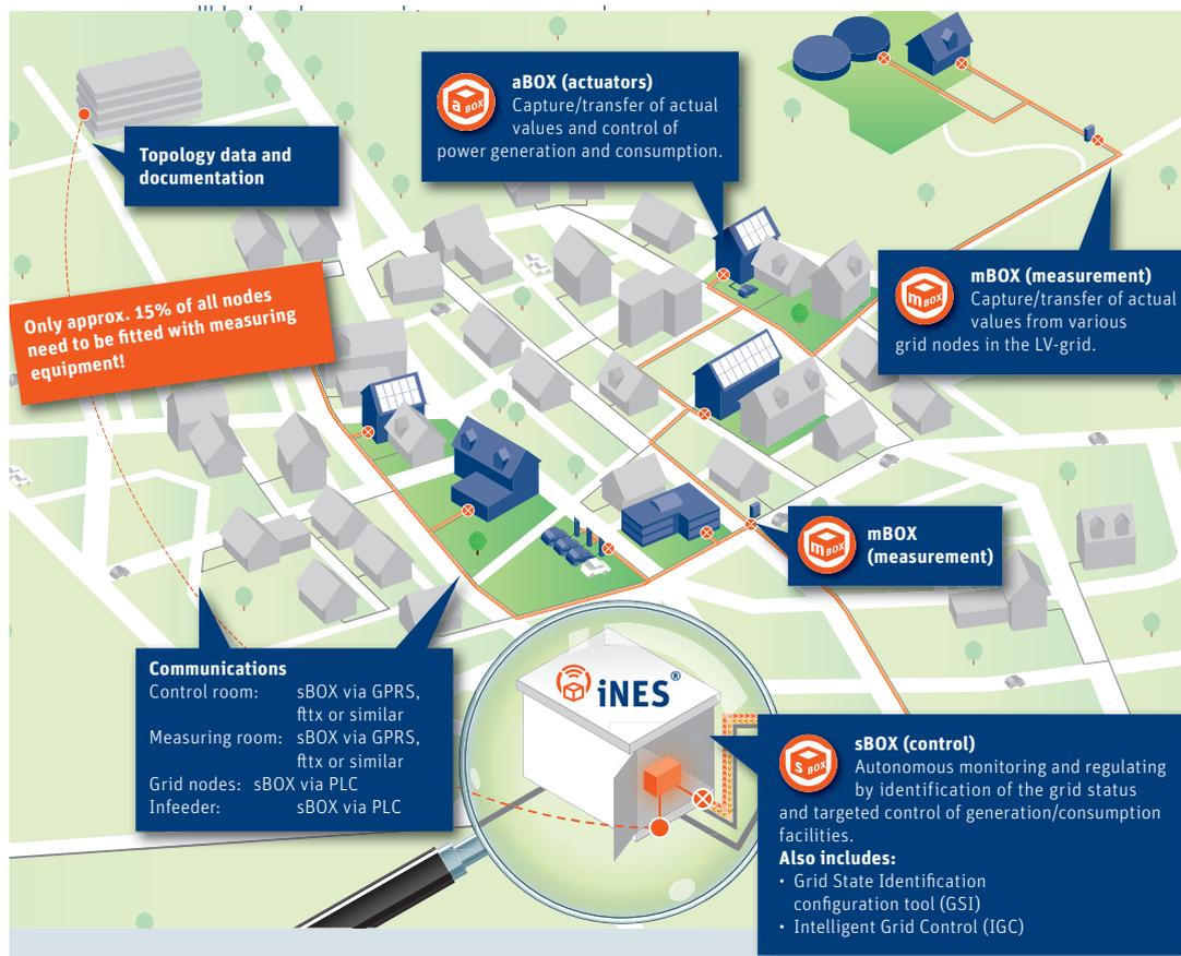
Figura 3.9: Rappresentazione qualitativa delle modalità di gestione e controllo di una rete BT secondo il progetto iNES®
