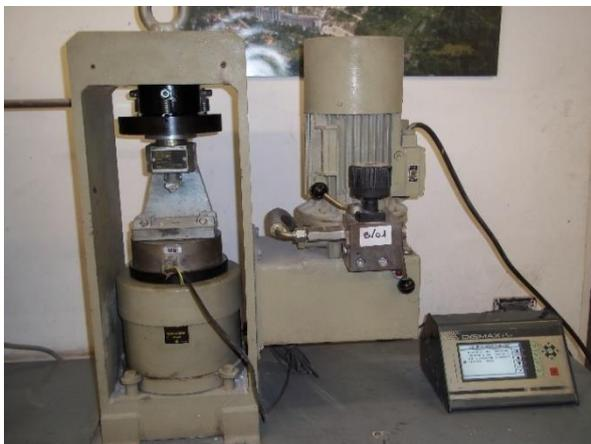
Figura 97 Apparecchiatura per prove a flessione e compressione
