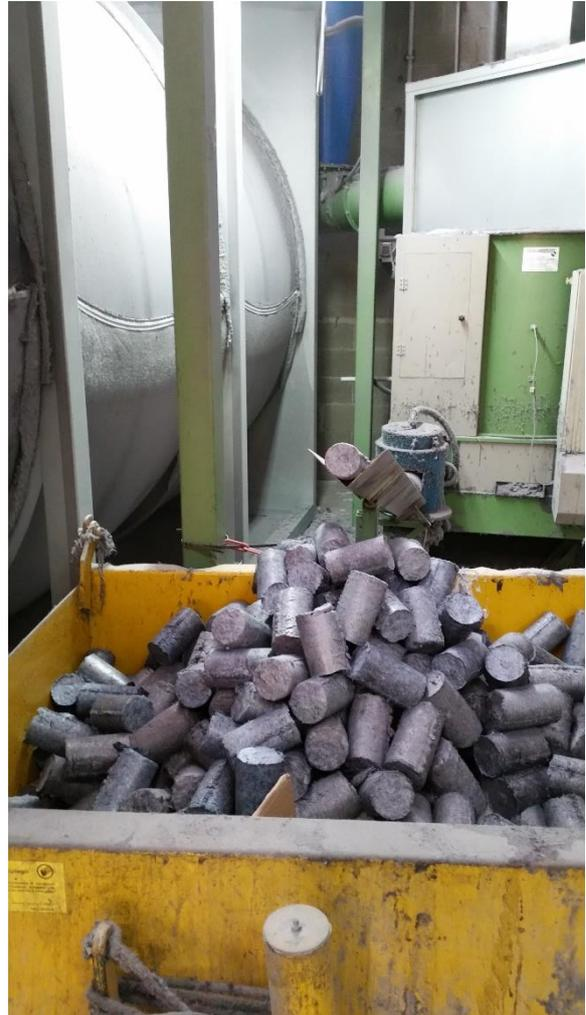
Figura 143 Stoccaggio polveri di aspirazione
