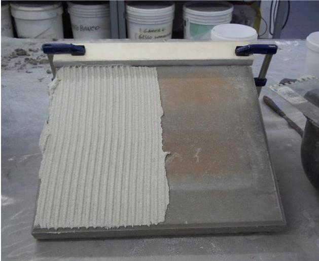
Figura 132 Rasatura supporto con spatola dentata
