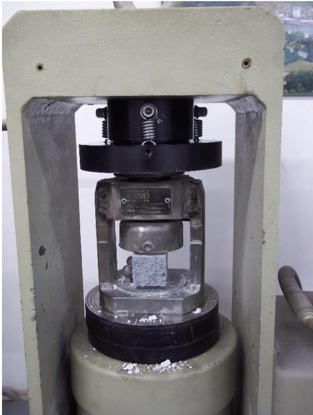
La prova è stata eseguita con un apparecchio composto da un piano di appoggio liscio con la funzione di base per il provino, il quale viene messo a piombo grazie a due stantuffi metallici con lo scopo di allinearli alla piastra superiore che distribuisce il carico.
