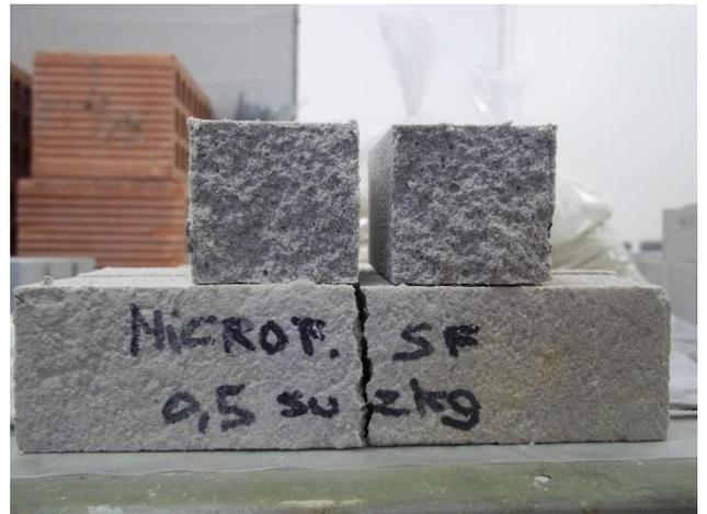
Figura 105 Provini BETON P16 + microfibre scarto sfilacciatura
