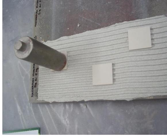
Figura 126 Posa piastrelle e applicazione peso di 2 kg
