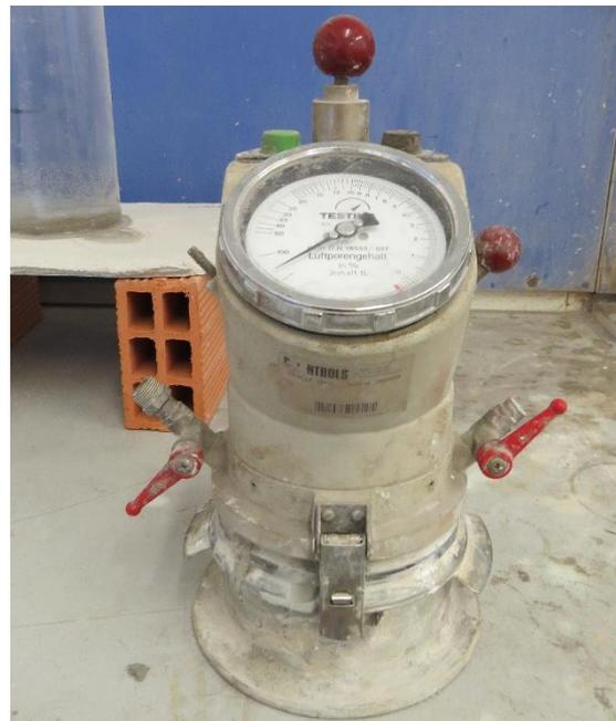
Figura 83 Determinazione aria impasto mediante porosimetro
