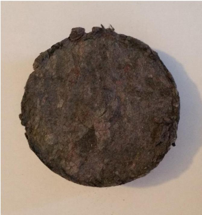
Figura 51 Polveri pressate in cilindri
