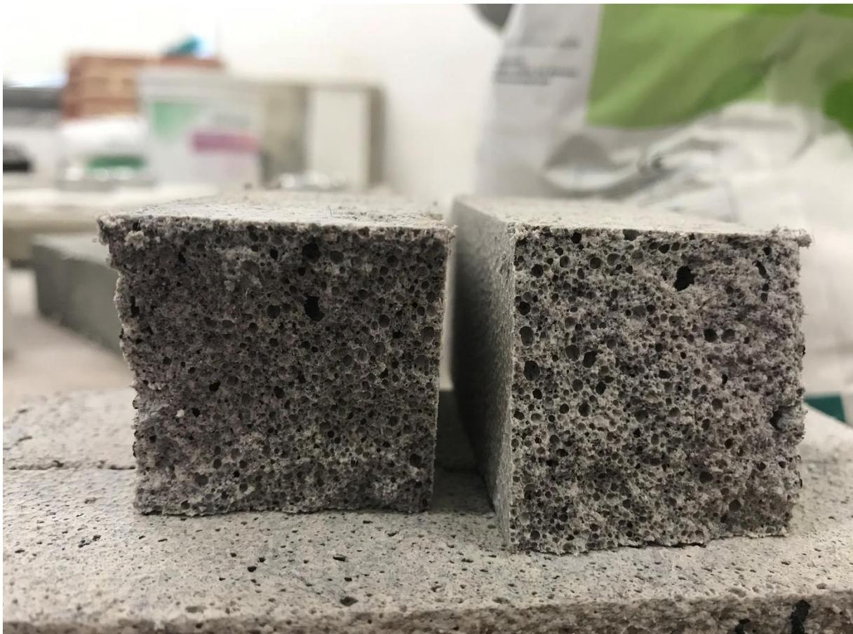
Figura 110 Provini BETON P16 con 7 g/kg microfibre L/C
