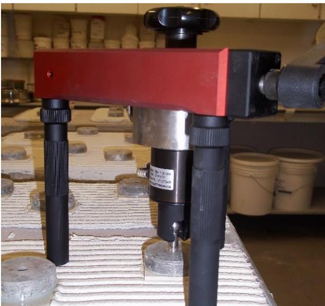
Figura 128 Prova con dinamometro.
