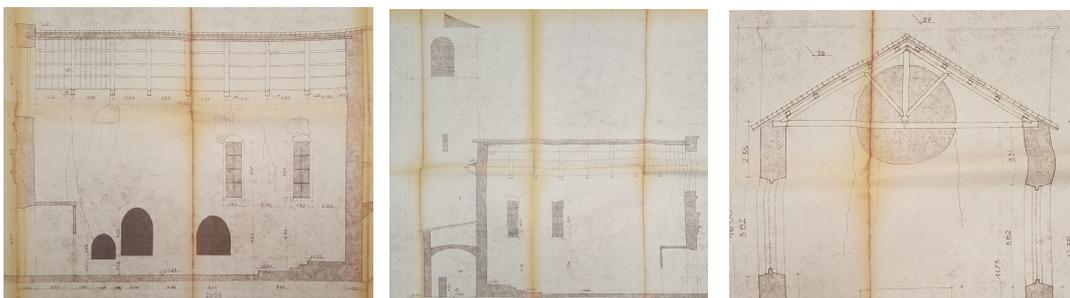
**Figura 3.11. Documenti del Rilievo 1980 da cui sono state ricavate le lesioni precedenti agli avvenimenti sismici del 2016/2017. (Img.1 lesioni corrispondenti al prospetto Ovest, Img.2 al prospetto Est, Img. 3 al prospetto principale.)**
