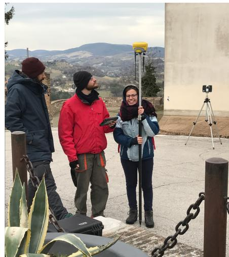
**Figura 1.5. Ricevitore mobile “Rover” GNSS<sup>28</sup>**
