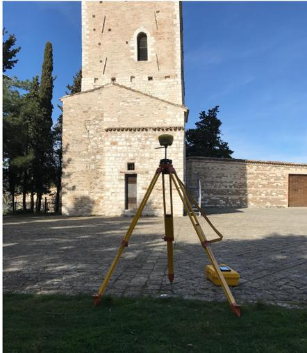
**Figura 1.4. Ricevitore fisso GNSS<sup>27</sup>**
