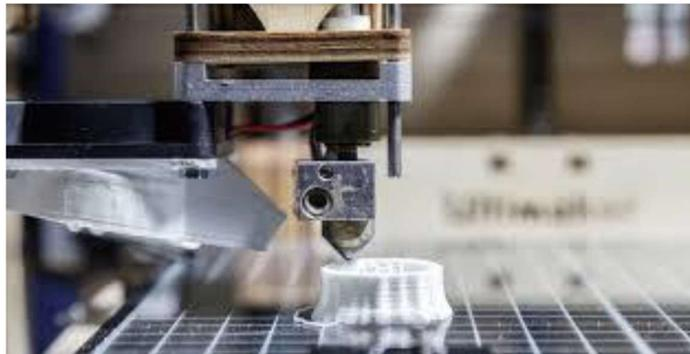
*Figura 1.7 – Un pezzo prodotto mediante additive manufacturing*
