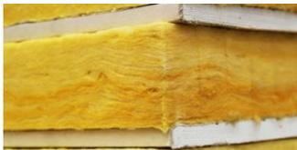
Figura 7: Materiale in fibra minerale [3a]
