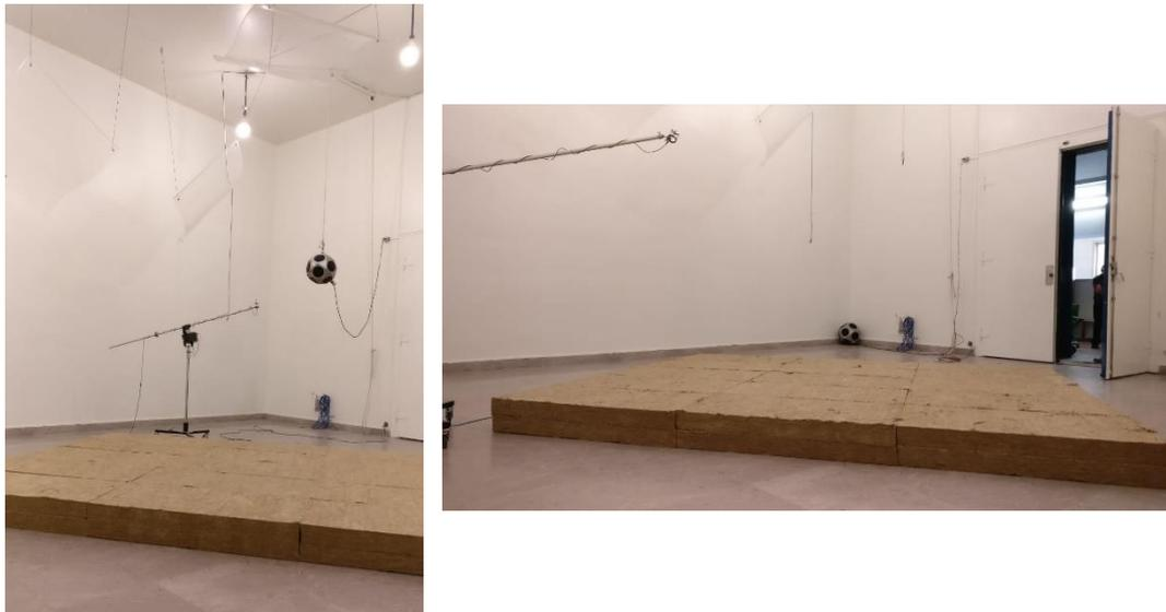
Figura 19: Esempio di camera riverberante 1:1 (Laboratorio di acustica - INRiM)
