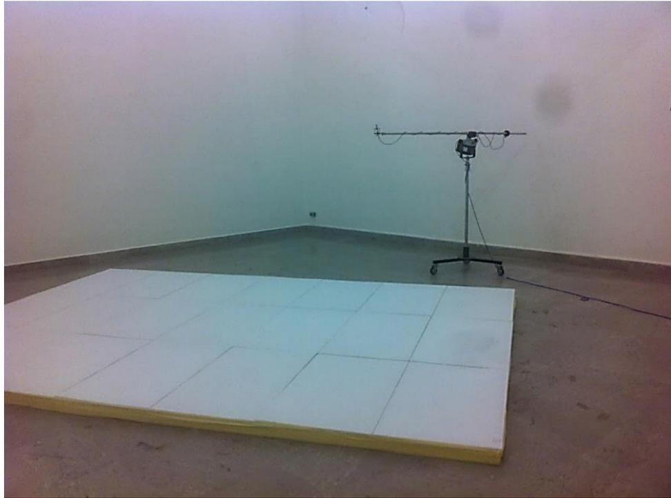
Figura 55: Campione di prova (D) nella camera riverberante
