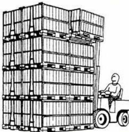
**Figura. 1.1.** “Magazzino a catasta” [8]
