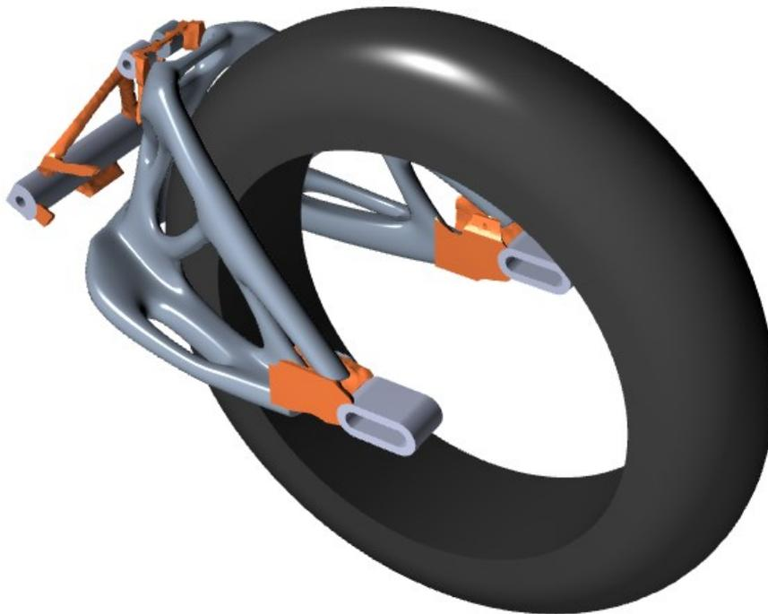
Figura 3.108 Modellazione *DS centrale*, verifica degli ingombri dello pneumatico
