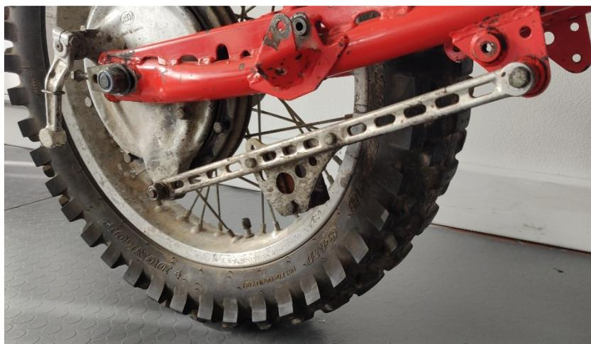
Figura 3.85 Sistema di bloccaggio freno a tamburo
