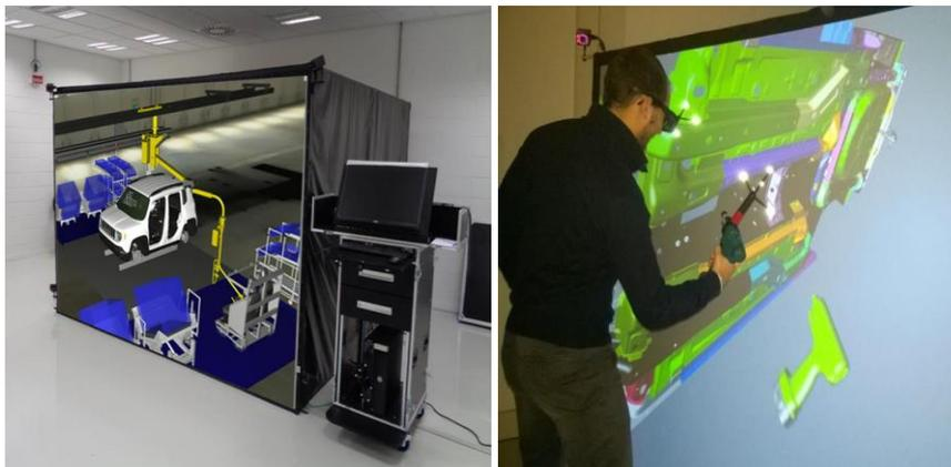
Figura 3.4 Simulazione operazione di montaggio
