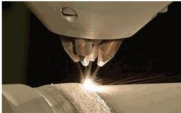
Figure 11 DMD utilizzata per riparare un componente
