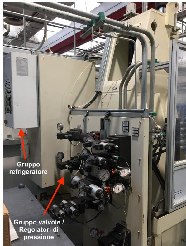
**Figura 1.24:** Particolare pressa idraulica: gruppo valvole, regolatori di pressione e gruppo refrigeratore
