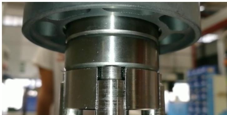
**Figura 4.12:** Test attrezzatura: fase 1 di piantaggio
