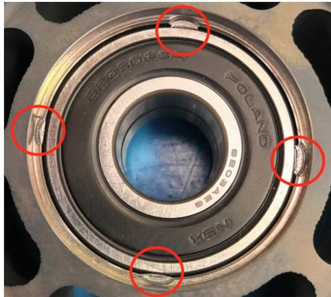
**Figura 4.8:** Punti di misurazione della profondità di giunzione a freddo
