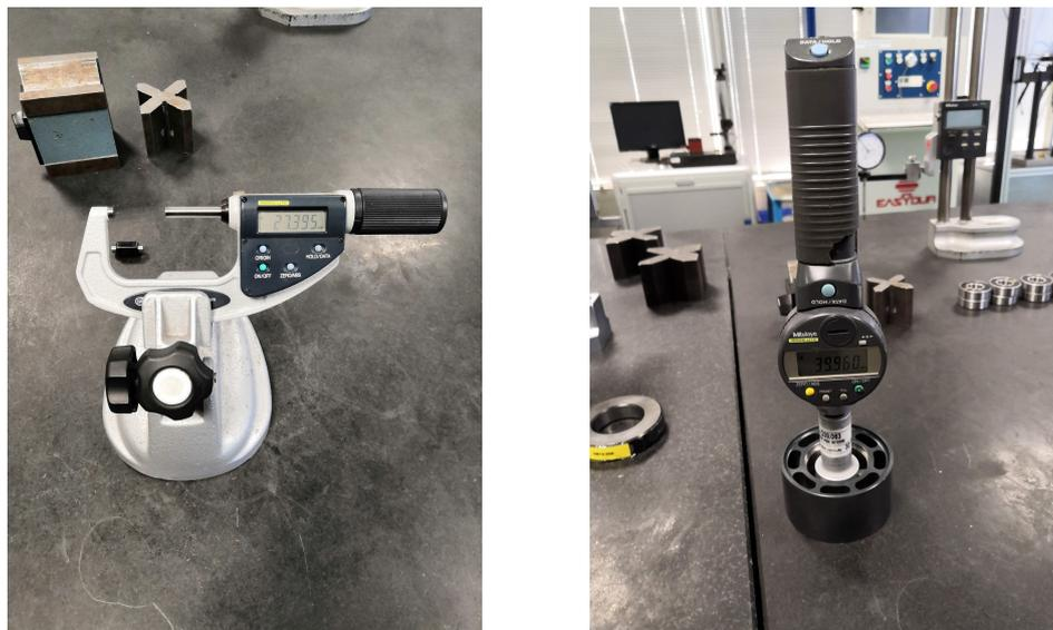
**Figura 3.4:** a) Micrometro per esterni; b) micrometro per interni
