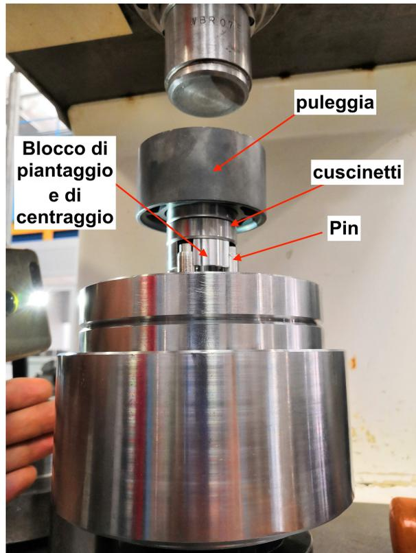
**Figura 4.1:** Banco di prova per il test di piantaggio e giunzione a freddo
