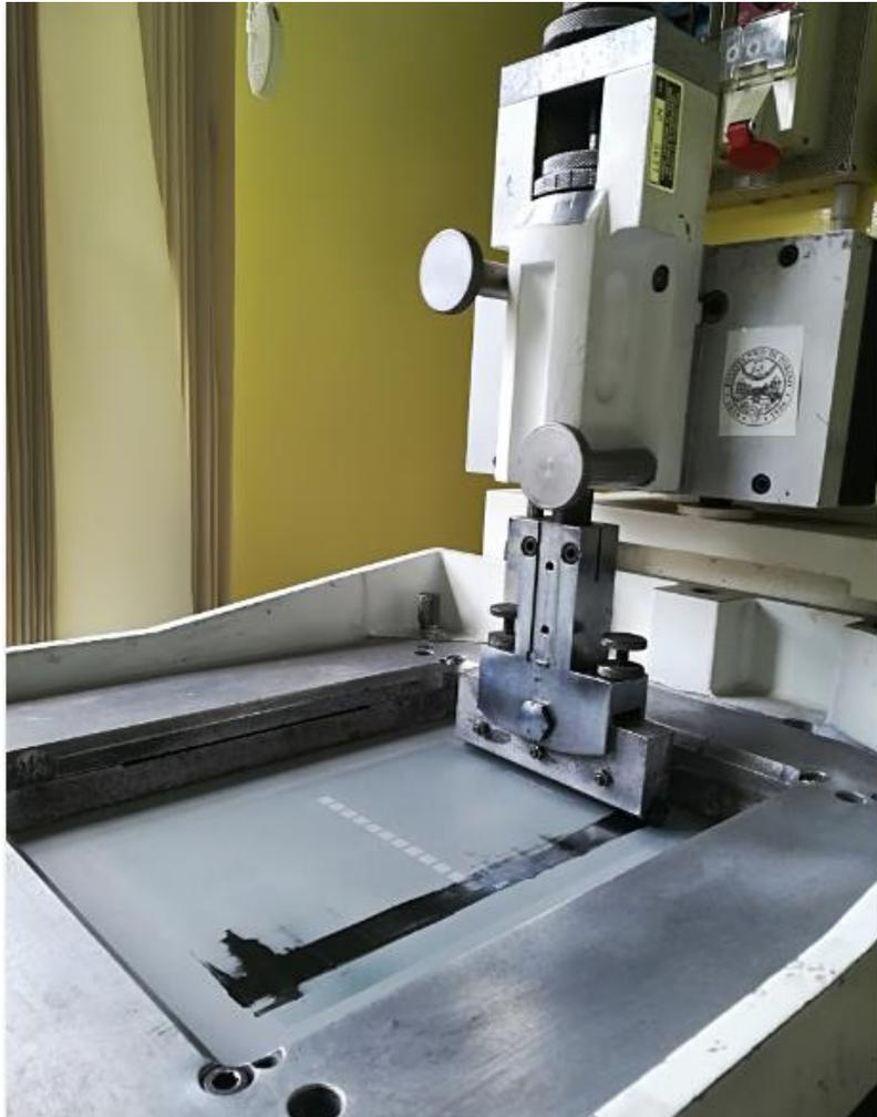
Figura 3.11. Macchina serigrafica durante il processo di screen printing dell'ossido di cobalto.
