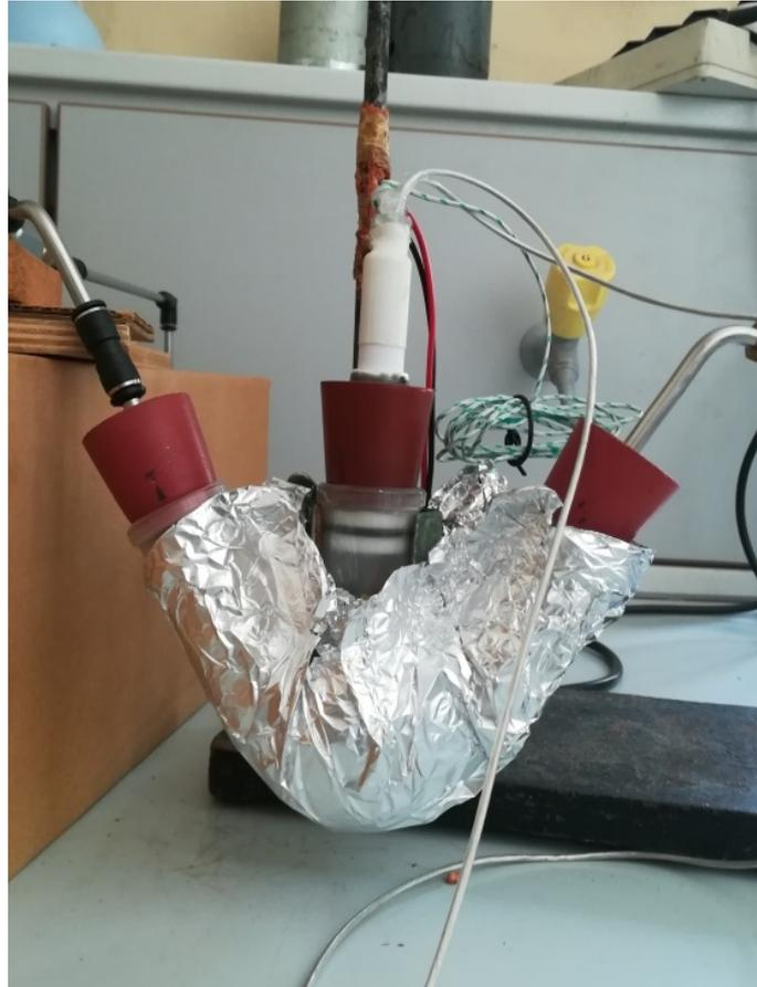
Figura 3.6. Foto della camera in cui è alloggiato il sensore durante le prove. All'interno il sensore si trova a contatto con un riscaldatore e due cavi per la misura dell'impedenza.
