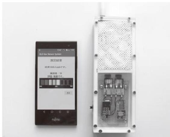
Figura 2.1. Prototipo del dispositivo di rilevazione di ammoniaca (a destra), all'interno sono visibili i sensori integrati nel device. A sinistra, lo smartphone in fase di ricezione dati via Bluetooth [15].
