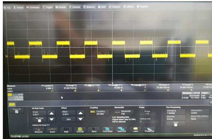
Figura 5.15. Foto della schermata dell'oscilloscopio, è rappresentata l'onda al pin di output del ring oscillator.
