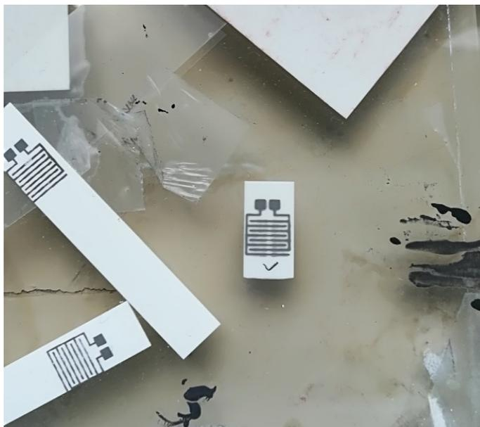
Figura 3.1. Substrato dei sensori chimici. Elettrodi in platino serigrafati sulla piastrina di allumina.
