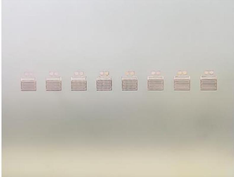
Figura 3.10. Maschera per la serigrafia degli elettrodi.
