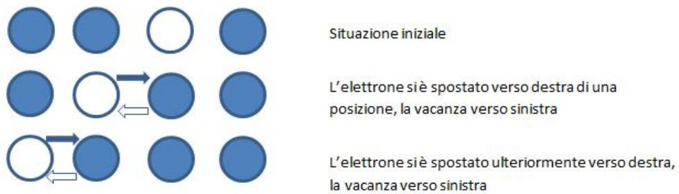
Figura 3.7. Schema che illustra lo spostamento delle lacune in maniera semplificata.
