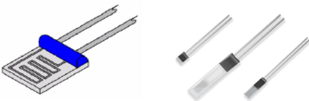
Figura 5.8. Tipologia costruttiva "a film sottile" per termoresistori [31].
