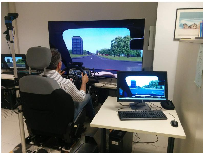
**Figura 5.2** – Setup sperimentale della prova di guida simulata: sullo schermo si vede l'evoluzione dello scenario durante la guida © CRF, 2018
