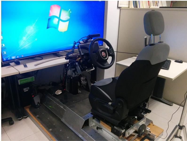
**Figura 3.3** – Setup sperimentale della prova di validazione. Al di sopra del volante si vede l’eye tracker FOVIO™ © CRF, 2018.
