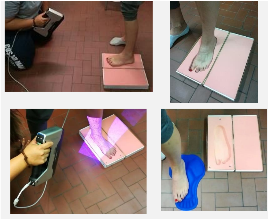
Figure 5.4 Scansione della gamba e successivamente della schiuma fenolica nella quale è impressa la forma del piede in condizioni di appoggio.
