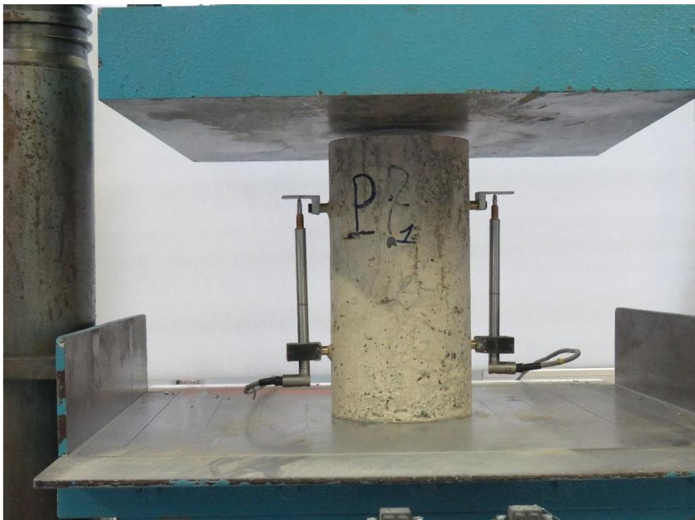
*Figura 3.10: Provino P1 prima dell'inizio della prova di compressione*
