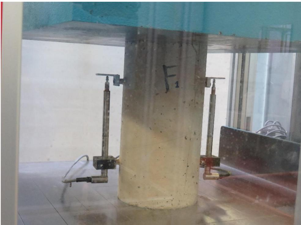
*Figura 3.17: Provino F1 prima dell'inizio della prova di compressione*
