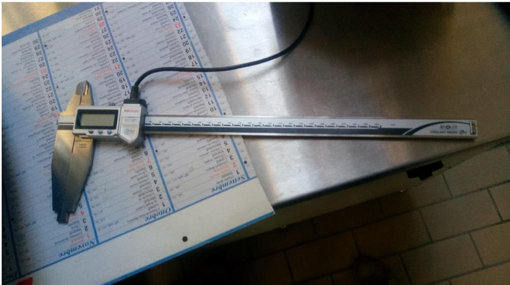
*Figura 3.9: Calibro utilizzato per misurare le dimensioni dei provini cilindrici*
