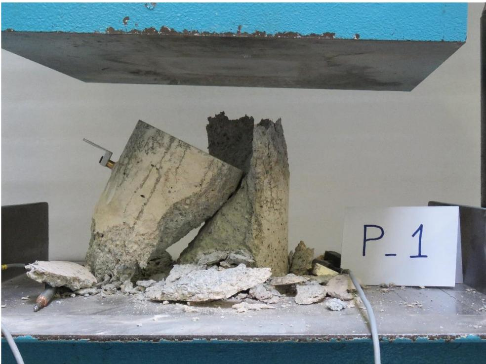
*Figura 3.12: Provino P1 al termine della prova di compressione, vista 2*
