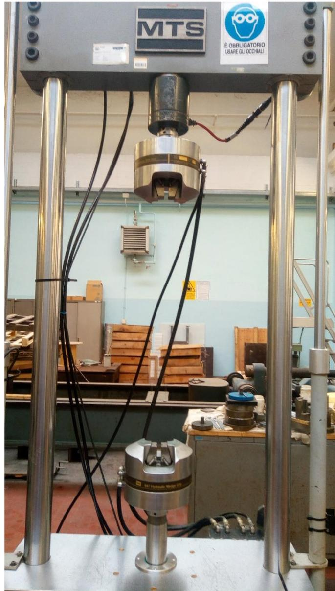
*Figura 3.26: Macchina MTS da 100 kN, utilizzata per la prova di trazione*
