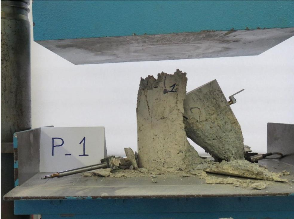
*Figura 3.11: Provino P1 al termine della prova di compressione, vista 1*
