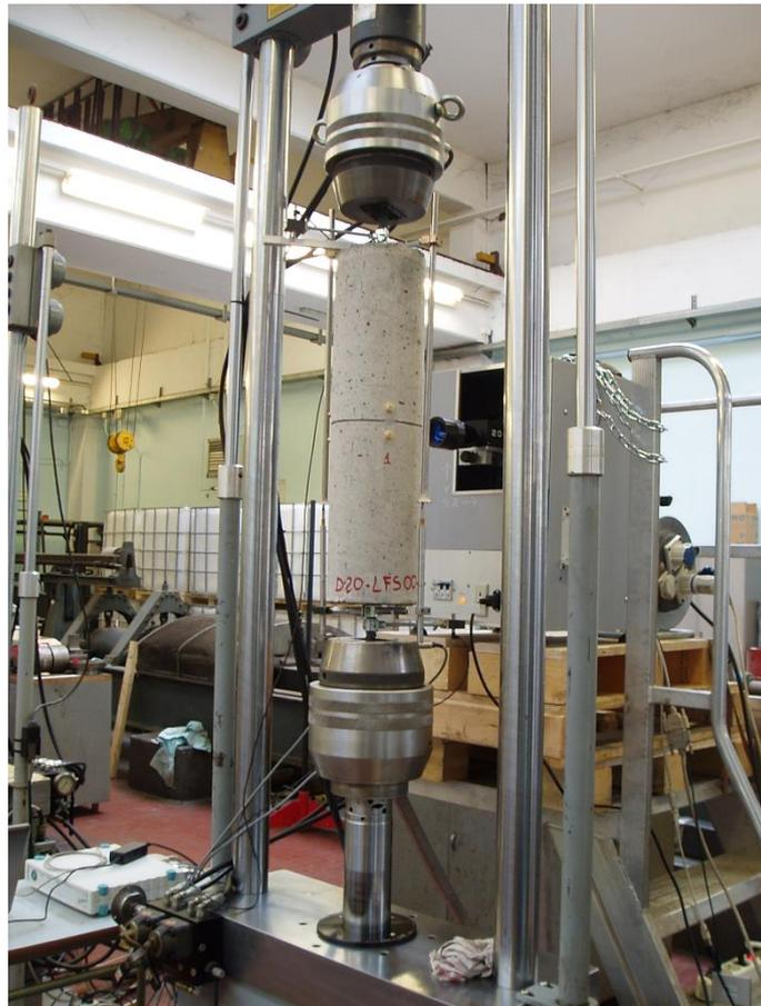
*Figura 3.4: Campione montato sulla macchina MTS*
