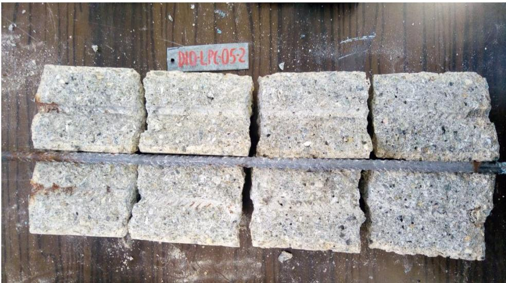
*Figura 3.40: Apertura del provino D10-LPC-05-2*
