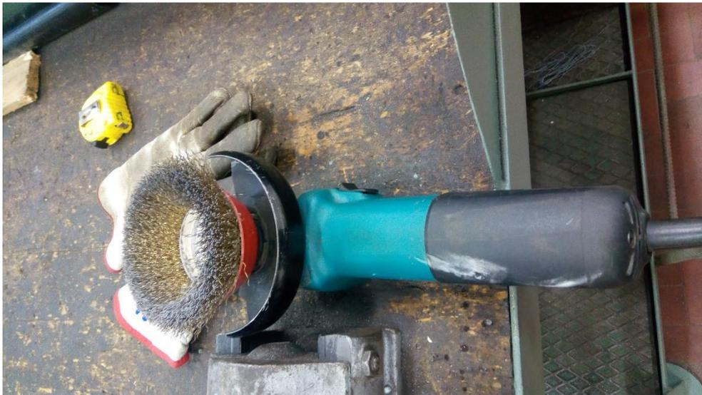
*Figura 3.39: Smerigliatrice angolare, utilizzata per pulire la barra*
