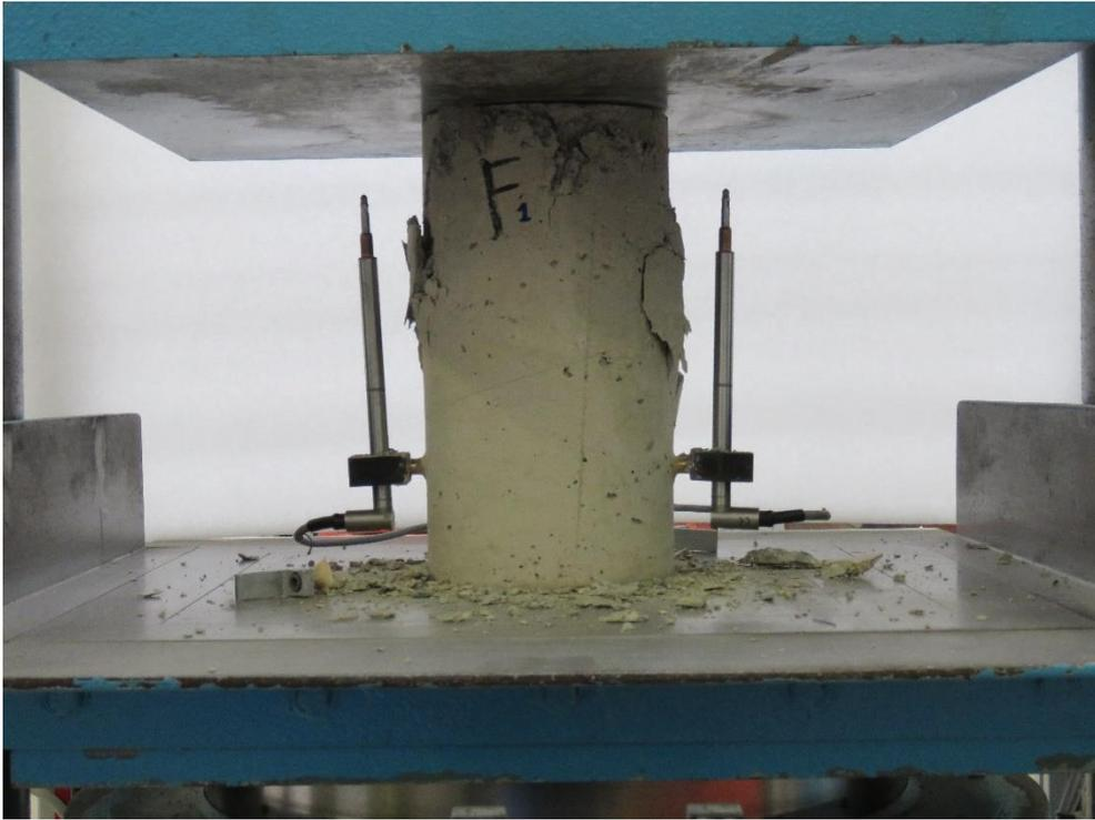
*Figura 3.18: Provino F1 al termine della prova di compressione, vista 1*
