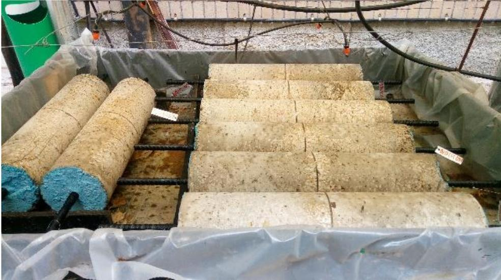
Figura 3.37: Provini all'interno della vasca dopo essere stati verniciati
