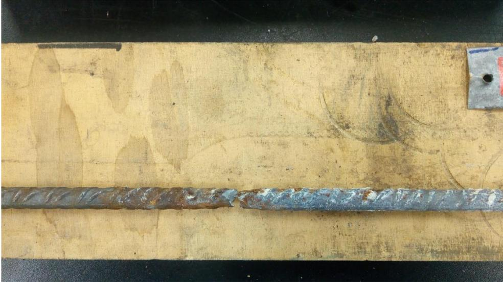
*Figura 3.41: Punto di rottura prima della pulizia, provino D10-LPC-05-2*
