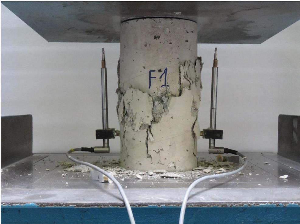
*Figura 3.19: Provino F1 al termine della prova di compressione, vista 2*
