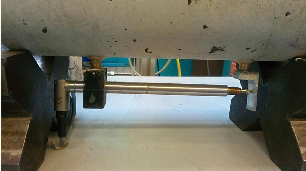
*Figura 3.8: Trasduttore Wa-20 applicato su un lato del provino cilindrico*
