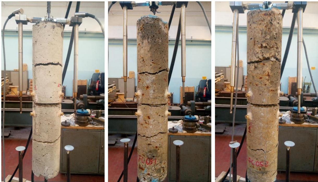
Figura 4.76: Foto dei provini in seguito alla rottura, da sinistra verso destra: D10-LFS-00-0, D10-LFC-05-1 e D10-LFC-05-2
