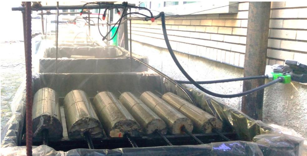
*Figura 3.36: Provini all'interno delle vasche durante l'operazione di lavaggio*
