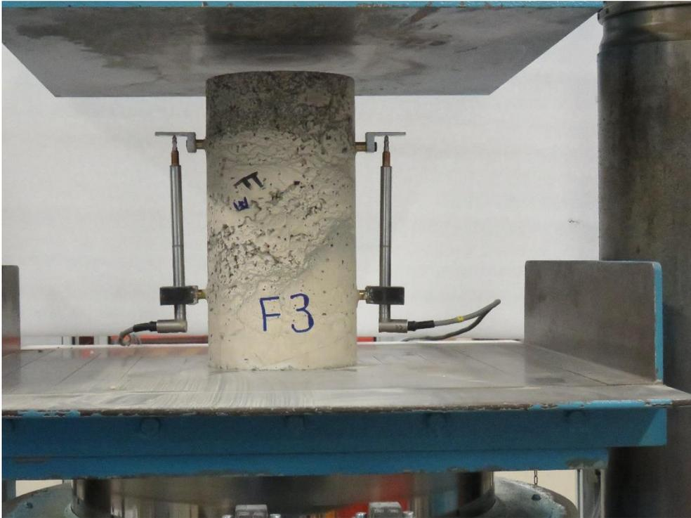
*Figura 3.16: Provino F3 prima dell'inizio della prova di compressione, nella sommità si possono osservare le notevoli porosità*
