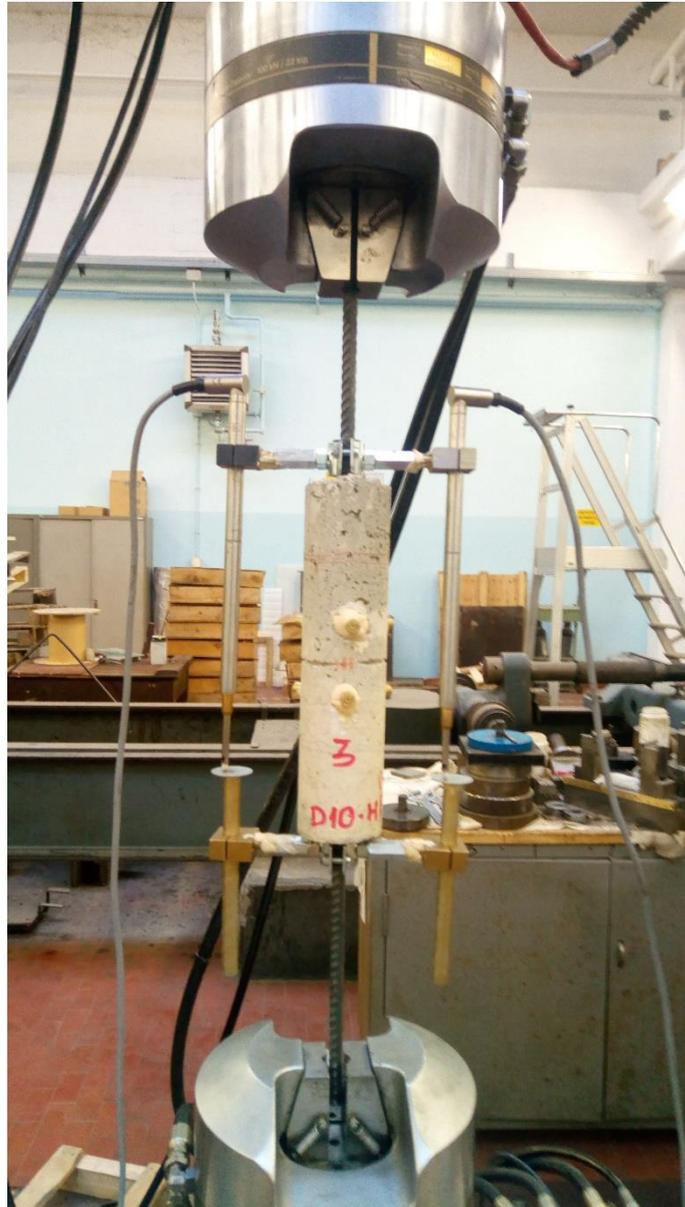
*Figura 3.25: Tirante D10-HFS-00-0 montato su macchina, con gli strumenti di misura*
