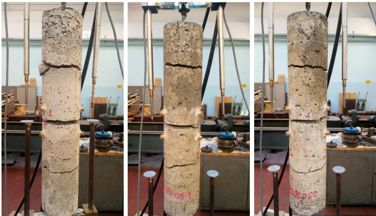
Figura 4.77: Foto dei provini in seguito alla rottura, da sinistra verso destra: D10-LPS-00-0, D10-LPC-05-1 e D10-LPC-05-2
