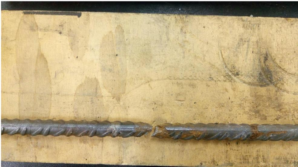
*Figura 3.42: Punto di rottura al termine della pulizia, provino D10-LPC-05-2*
