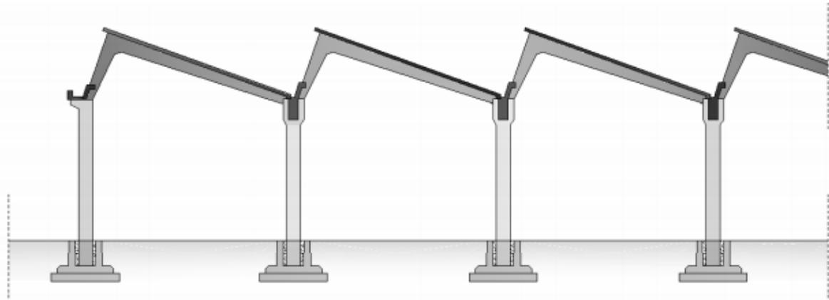
Figura 2.14. Struttura con copertura a Shed
