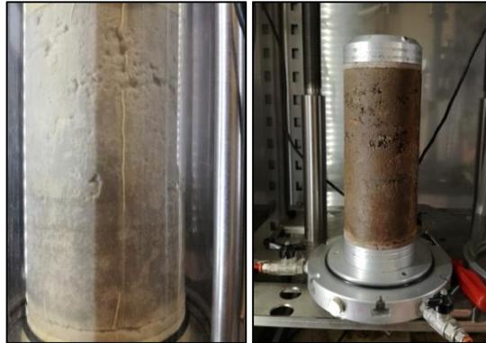
Figura 28: Rivestimento del provino con guaina in lattice e preparazione del provino da inserire in cella triassiale.
