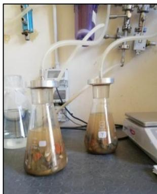
Figura 12: Procedura MMVT: de-aerazione della miscela tramite aspirazione.
