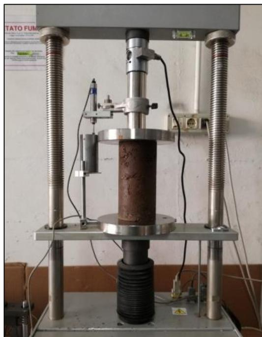
Figura 31: Procedura di prova a compressione non confinata.
