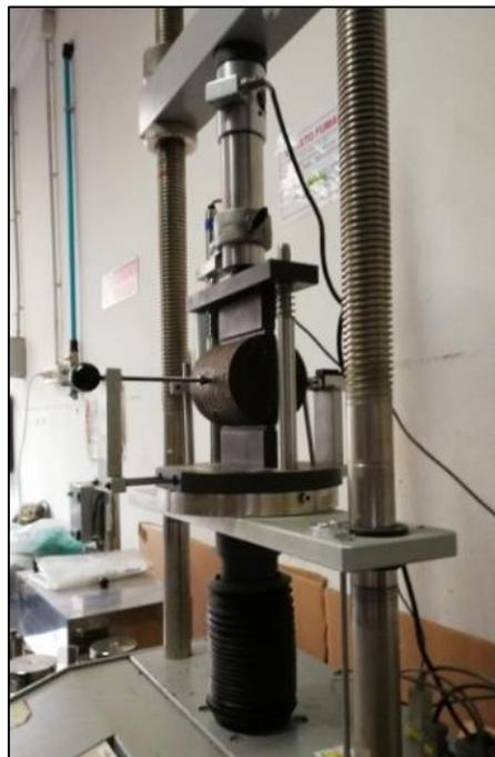
Figura 35: Procedura di prova per la trazione indiretta.
