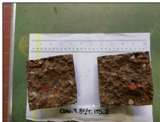
Figura 34: Campione rotto a trazione indiretta.
