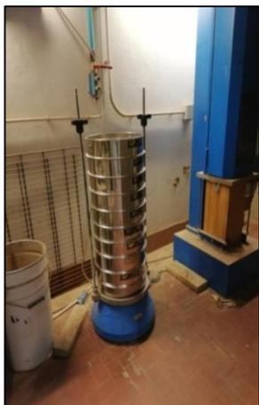
Figura 8: Colonna setacci montata sul setacciatore elettromagnetico.
