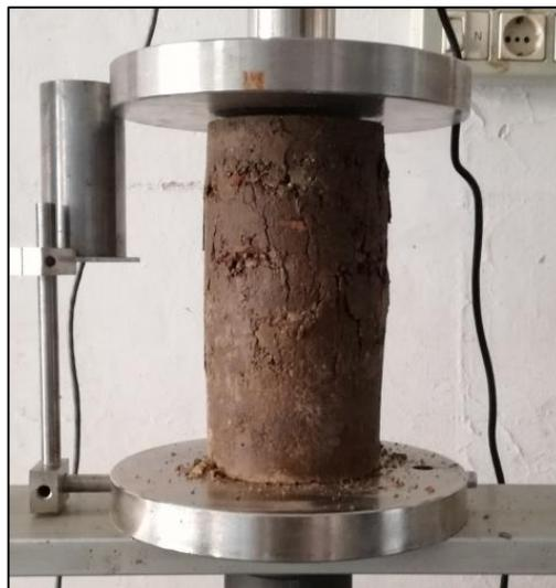
Figura 32: Rottura del provino dovuta alla progressiva fessurazione.
