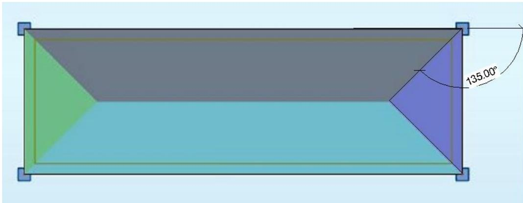
Figura 198: Definizione geometrica dell'area di influenza delle travi.
