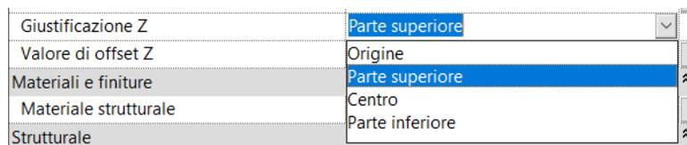
Figura 39: Posizionamento trave rispetto all'asse z.
