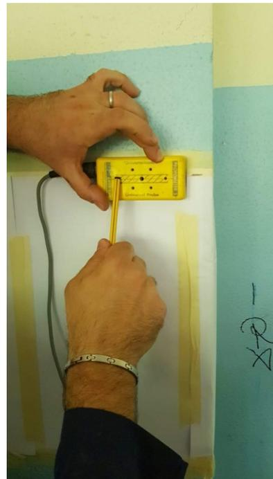
Figura 121: Unità di emissione e lettura del campo magnetico/sonda emittente e ricevente il campo magnetico.
