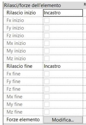
**Figura 86: Tipologia di vincolo agli estremi dell'elemento analitico.**
