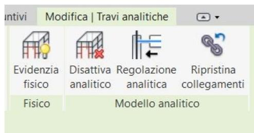
**Figura 78: Possibilità per la gestione dell'elemento analitico in ambiente Revit.**
