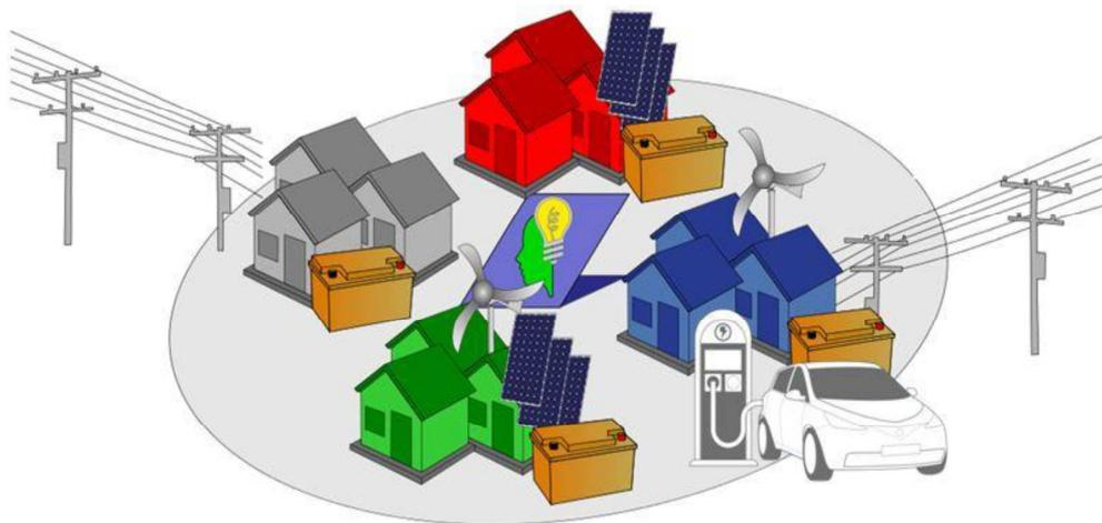
Figura 43 Schema rappresentativo di una microgrid (fonte:[6])
