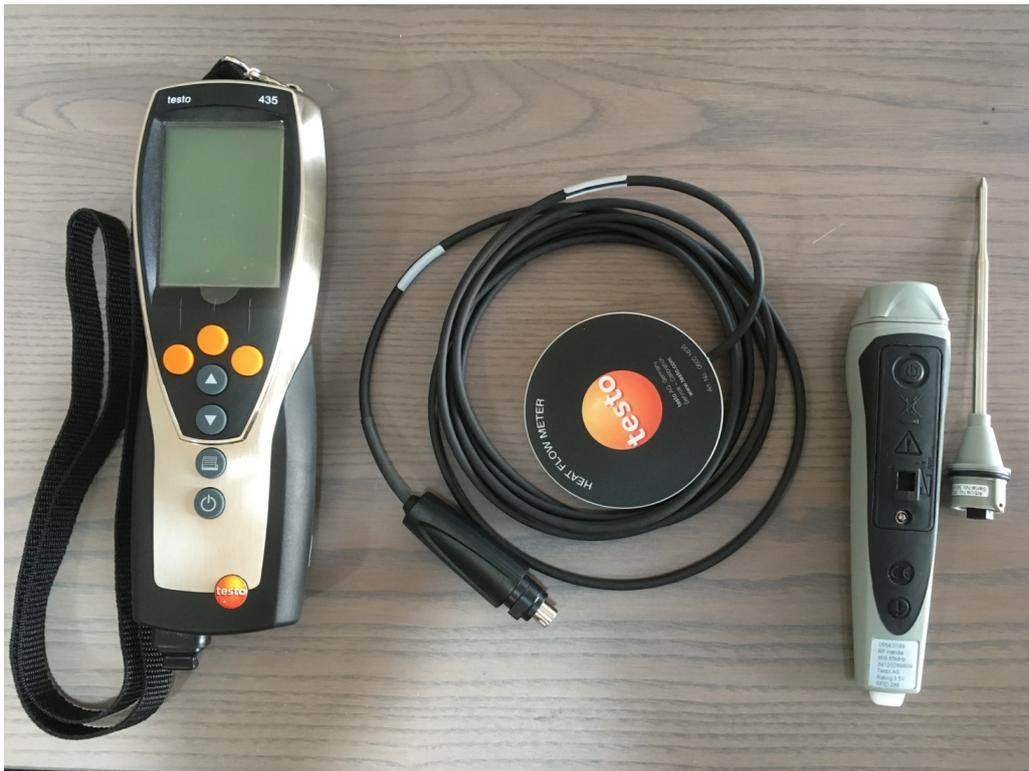
Figura 38 strumento multifunzione con sonda termoflussimetrica
