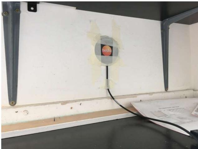
*Figura 41*posizionamento sonda termoflussimetrica 2
