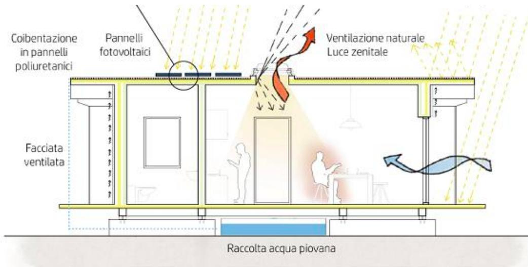
Figura 1.4: Sezione del modulo abitativo PER-E-House
