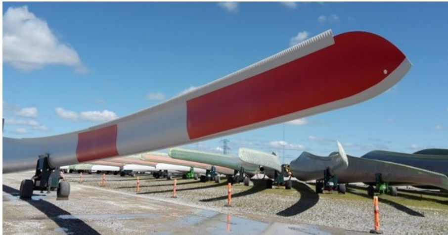
Figura 1: Pala di turbina eolica con bordo di fuga dentellato
