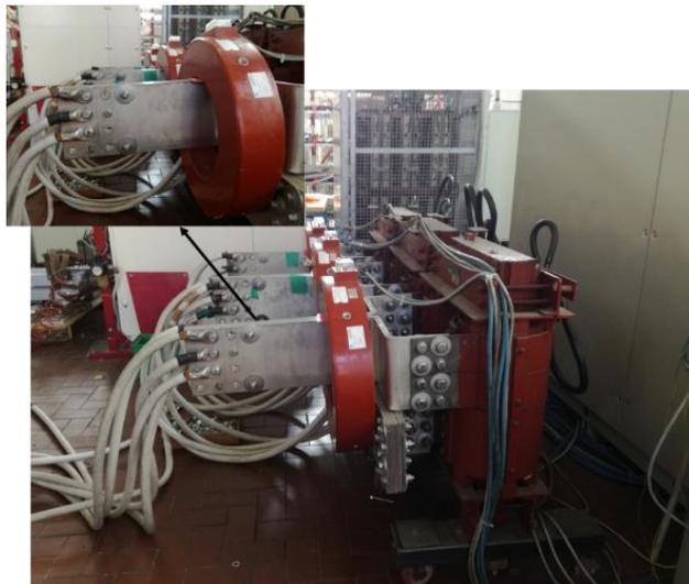
**Fig.15** Trasformatore elevatore di corrente utilizzato per le prove di sovratemperature
