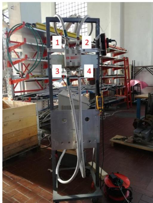
**Fig.48** Identificazione dei differenti capicorda utilizzati durante le prove di sovratemperatura
