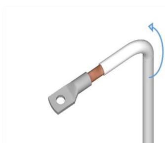
**Fig.19 Rotazione di un conduttore di prova intorno al piano del capocorda**
