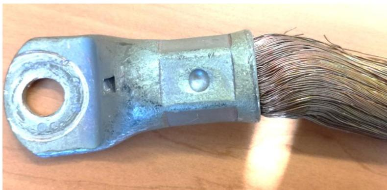
Fig.51 Esempio di un tratto di conduttore nudo ossidatosi pur non avendo una resistenza di crimpatura elevata
