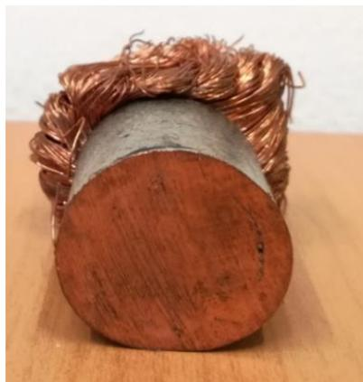
**Fig.56** Sezionamento di un capocorda
