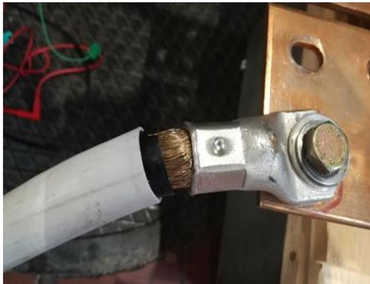
**Fig.41 Ossidazione del tratto di conduttore nudo**
