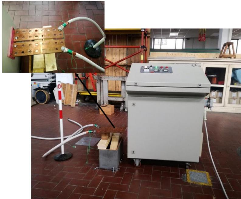
Fig.22 Schema di prova con zoom del collegamento dei capicorda alle barre
