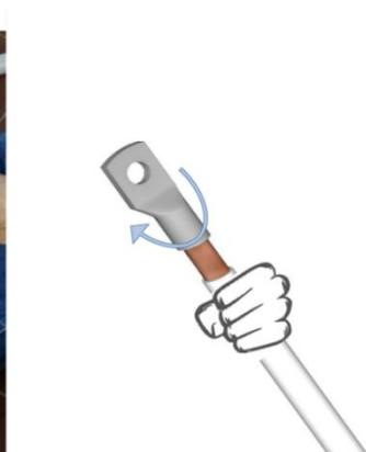
**Fig.17 Torsione di un conduttore di prova intorno al proprio asse di simmetria**
