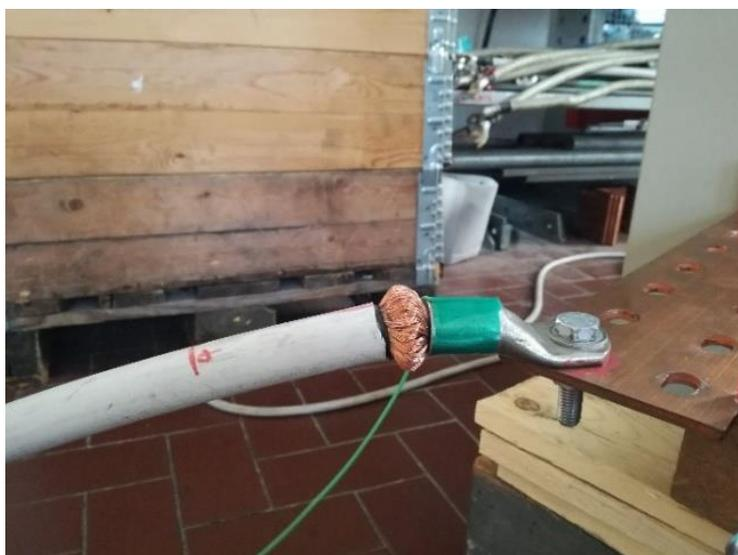
**Fig.29 Rigonfiamento della zona del conduttore nudo**
