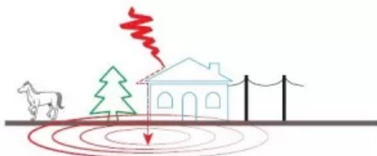
Figura 1.3: Fulminazione diretta edificio
