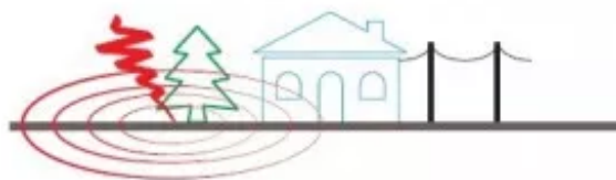
Figura 1.4: Fulminazione indiretta edificio
