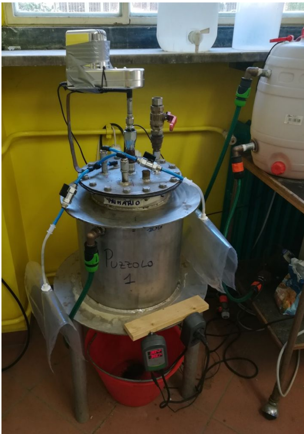
Figura 1: reattori impiegati in laboratorio per la digestione anaerobica del fango primario (a sinistra) e del lisato (a destra).
