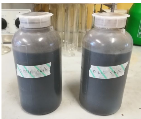
Figura 2: campioni di fango primario (a sinistra) e di lisato (a destra) estratti dai rispettivi digestori tramite la fase di scarico.
