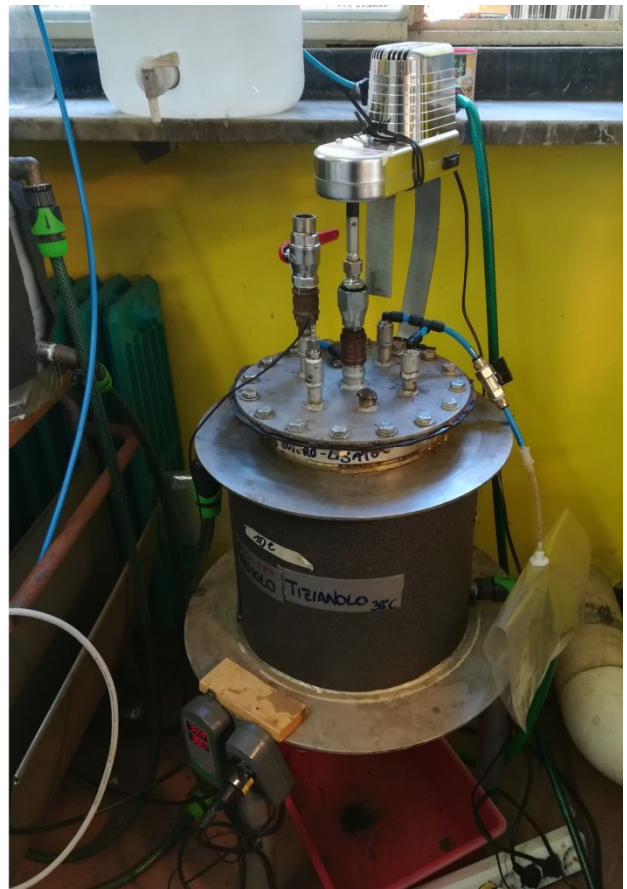
Figura 1: reattori impiegati in laboratorio per la digestione anaerobica del fango primario (a sinistra) e del lisato (a destra).
