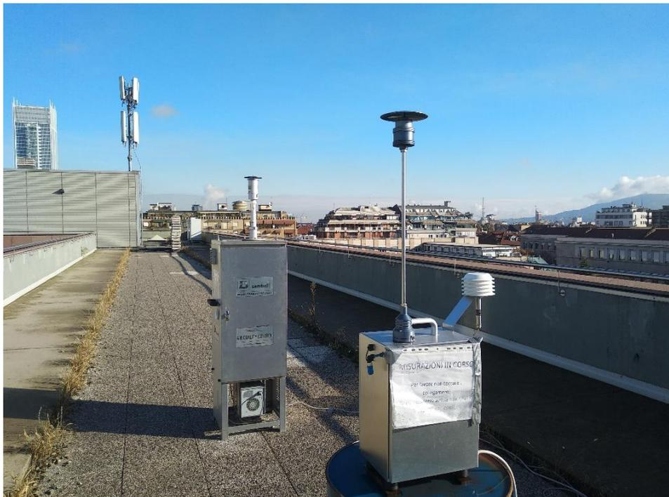
Figura 6.1-1 Strumenti utilizzati per la determinazione del particolato presso il sito-obiettivo del tetto verde presso il Politecnico di Torino.
