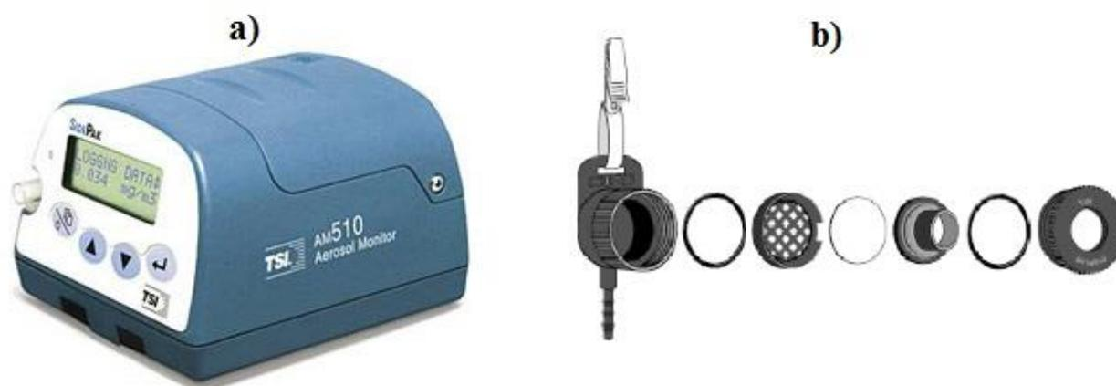
Figura 5.1-2 a) SidePak Personal Aerosol Monitor AM510 [113]. b) Testa di campionamento IOM. Le componenti, da sinistra verso destra, sono: corpo del campionatore, anello o-ring del corpo, fondo del porta-filtro, filtro, parte superiore del porta-filtro, o-ring della piastra anteriore, piastra anteriore [114].
