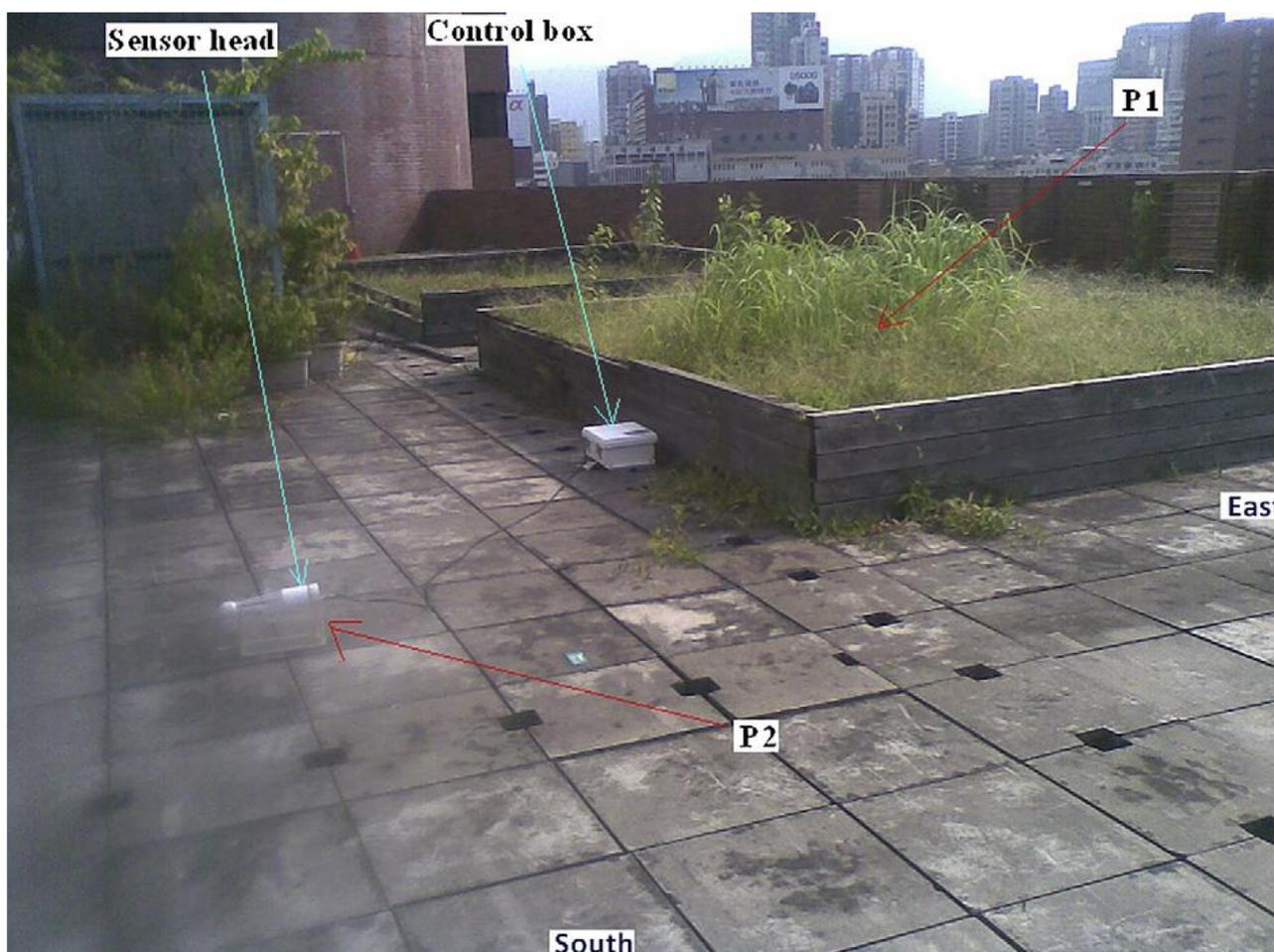
Figura 5.5-14 Setup delle misure in campo. P1 e P2 indicano l’ubicazione degli strumenti [146].
