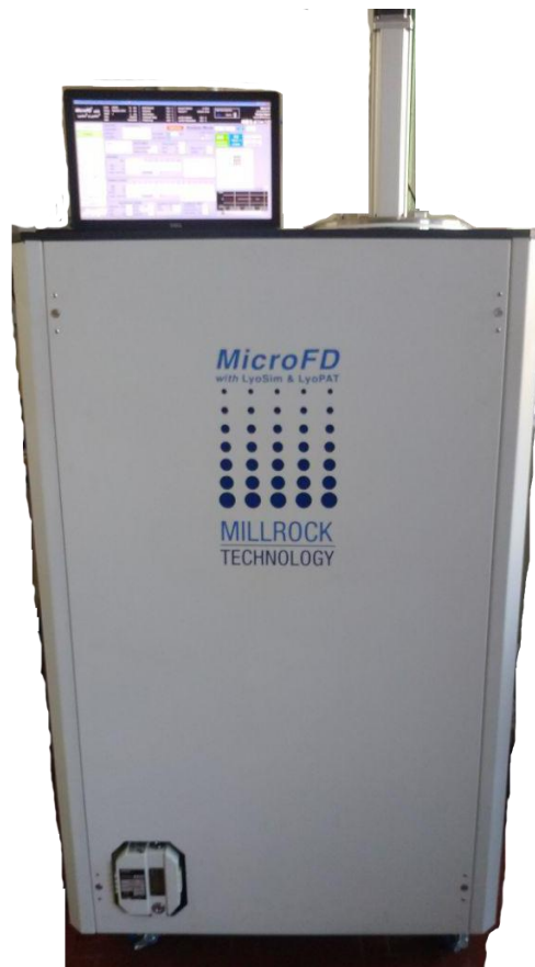
Figura 2.3 MicroFD ®. Dimensioni di 51cm x 76 cm con un'altezza di 170 cm. Peso di circa 136 kg.
