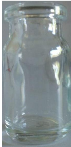
Figura 2.13 Flacone Molded . Si nota la struttura irregolare delle pareti e del fondo, molto più spesso rispetto ai flaconi tubolari.
