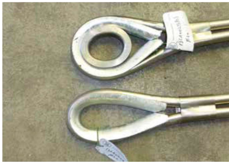
Figura 26 – Deformazione delle asole normale (quella sotto) e rinforzata (quella sopra) alle prove a rottura. Si nota immediatamente un diverso comportamento (immagine tratta dalla rivista Scienza & Mestieri numero 2/2014, pag. 11).
