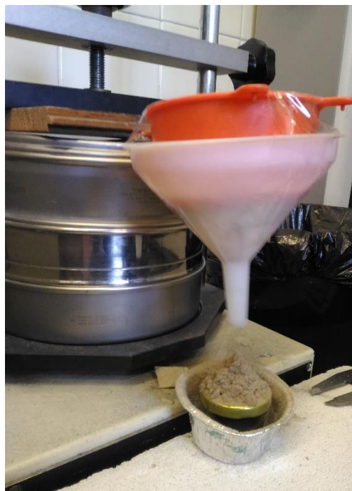
Figura 6.14 esempio di cumulo per la misurazione dell'angolo di riposo
