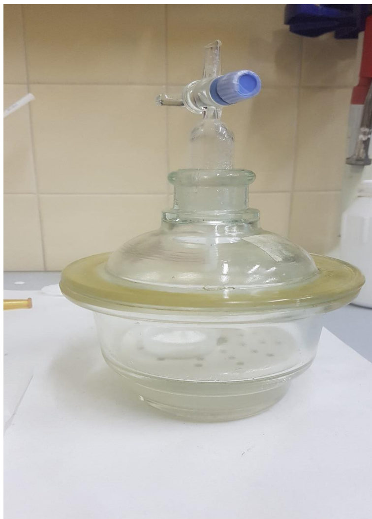
Figura 4.3: Campione Meso-ZnO_HC_15% in essiccatore
