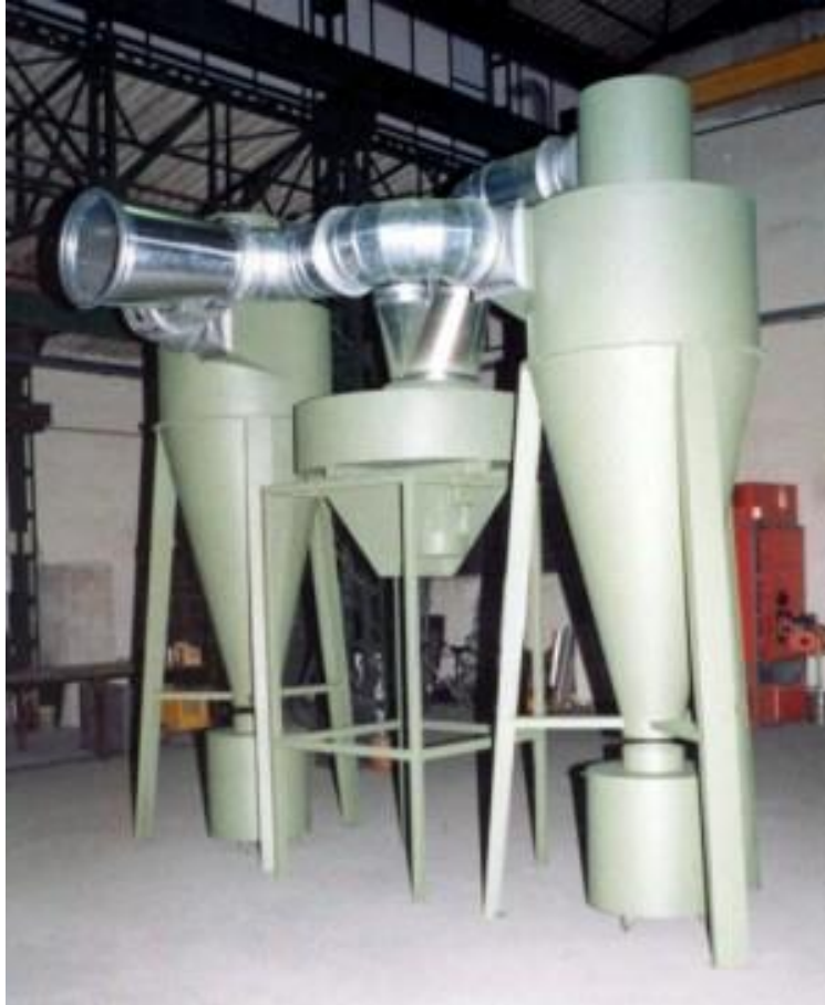
Figura 2.22: Coppia di Cicloni per abbattimento polveri [22]
