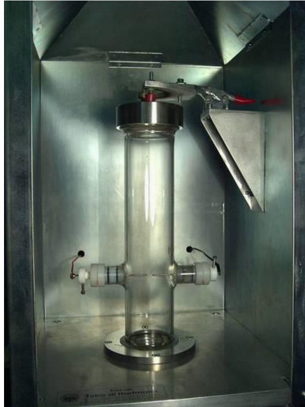
Figura 3.6: Tubo Hartmann con inneschi ad arco continuo
