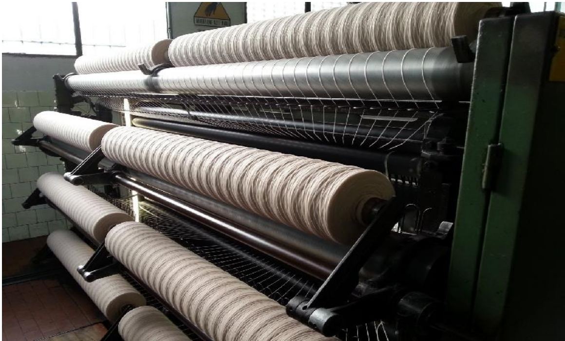
Figura 2.15: Apparecchiatura per la suddivisione del nastro in stoppini [16]
