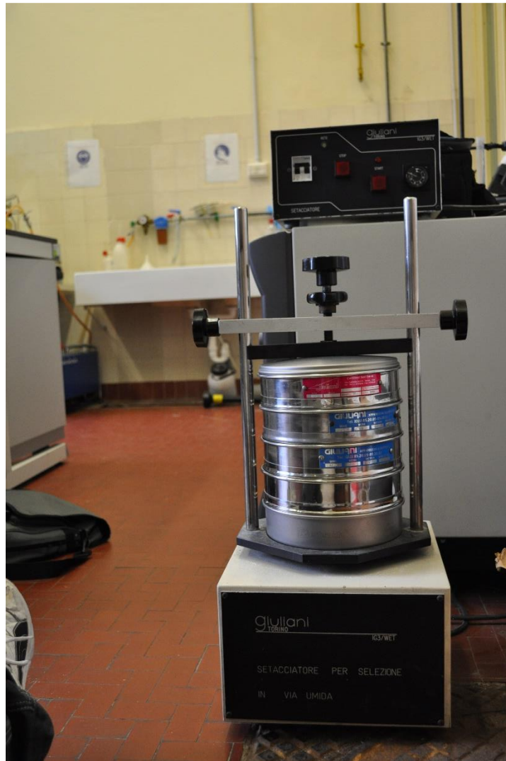
Figura 3.1: Setacciatore meccanico a vibrazioni
