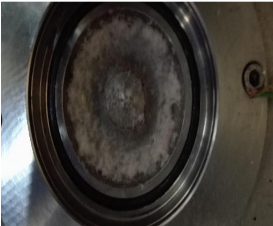
Figura 3.13: Campione di polvere disperso dopo la prova
