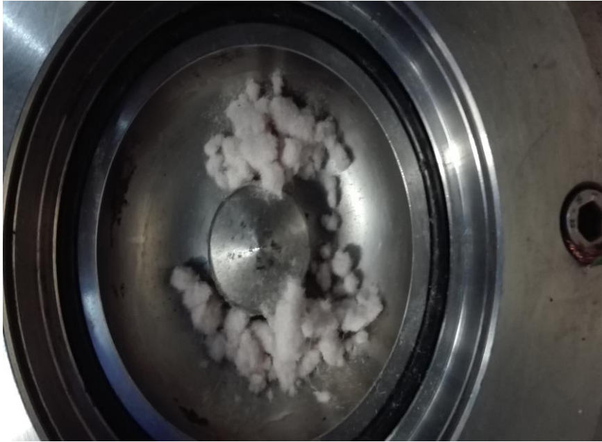
Figura 3.12: Campione prima della prova nel tubo Hartmann
