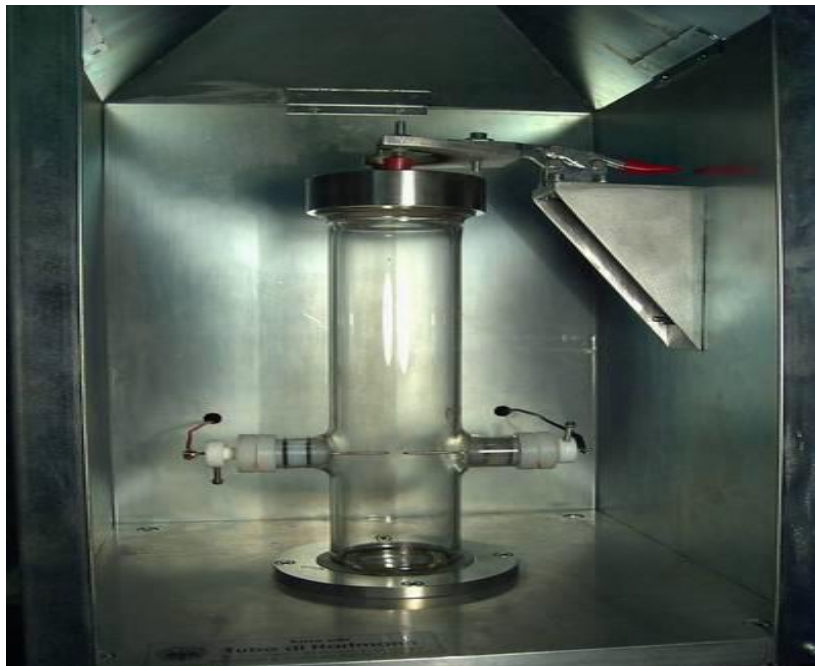
Figura 3.11: Tubo Hartmann usato nelle prove in cieco per valutare l'indice di disperdibilità
