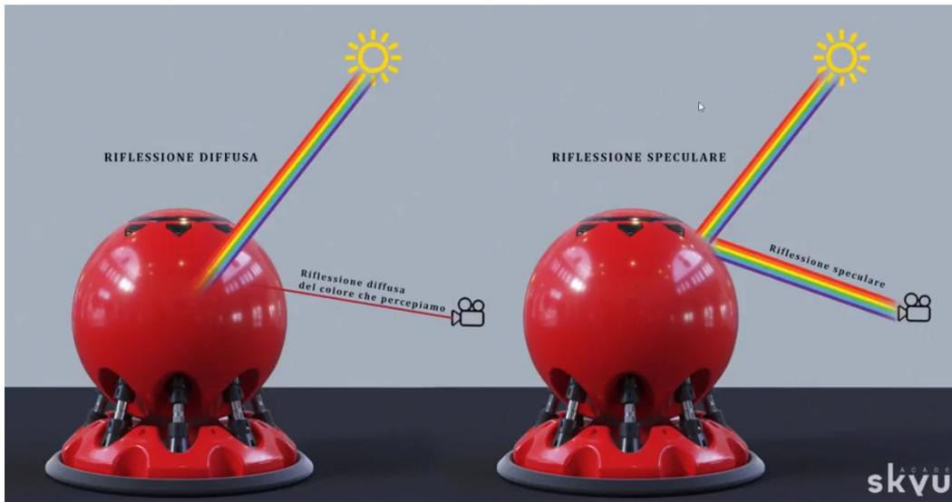
La riflessione diffusa è un tipo di riflessione omogeneo, ovvero i raggi vanno in tutte le direzioni in maniera omogenea a differenza della riflessione speculare che è diversa a quella diffusa, in questo caso, i fotoni vengono tutti riflessi ma non omogeneamente per capire meglio il concetto si spiega *l'effetto Fresnel*:
