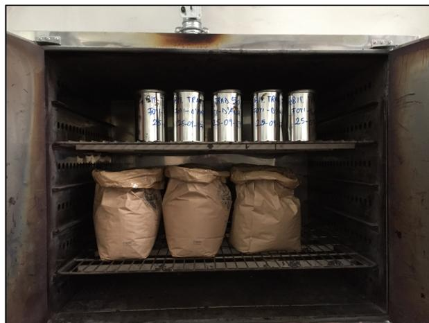
Figura 2.4: Materiale pronto per essere riscaldato alla temperatura di miscelazione.
