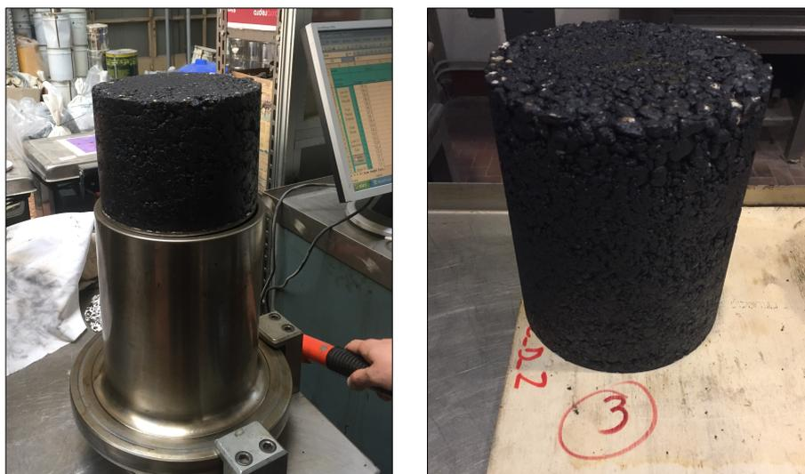
**Figura 3.9: Estrusione del campione e campione estruso.**
