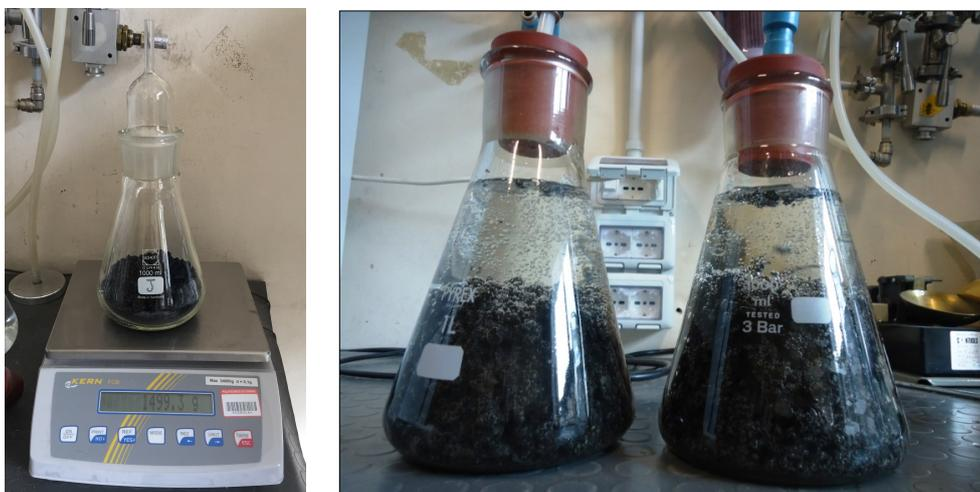
Figura 3.7: Picnometro riempito con materiale e operazione di disaerazione.
