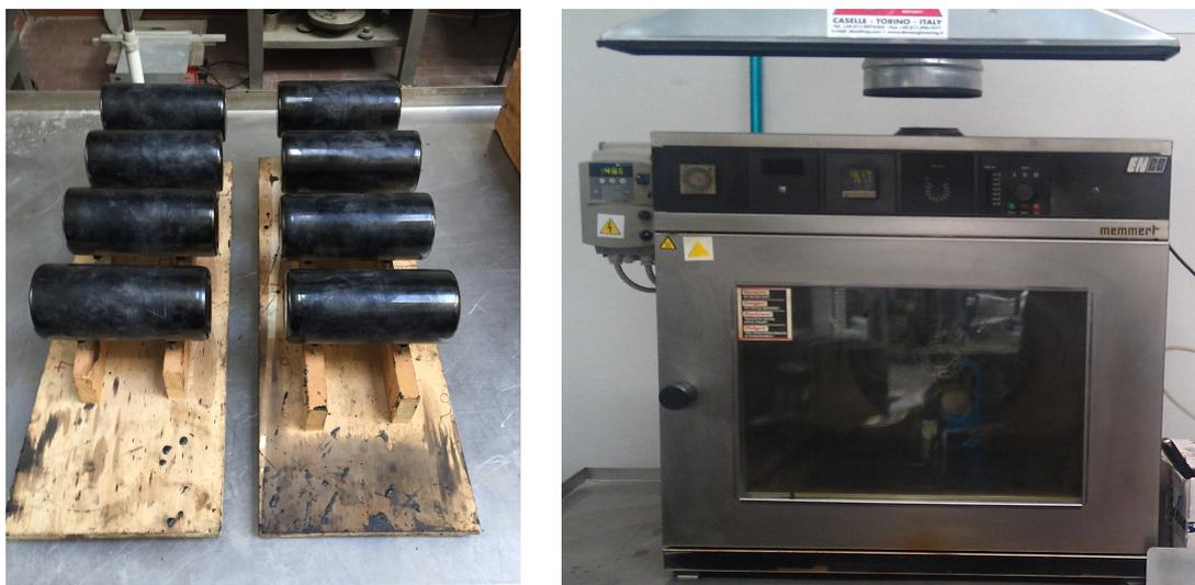
**Figura 3.3: Bicchieri cilindrici e forno usato per RTFOT.**
