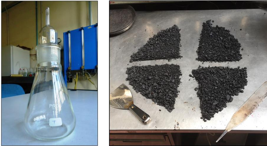
Figura 3.6: Picnometro vuoto e campioni di conglomerato bituminoso.
