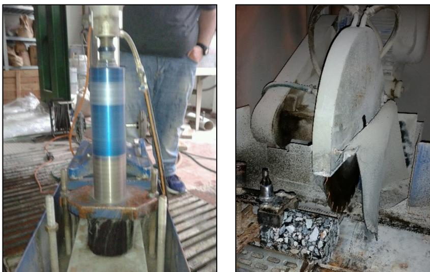
Figura 2.6: Operazione di carotaggio e taglio campione.
