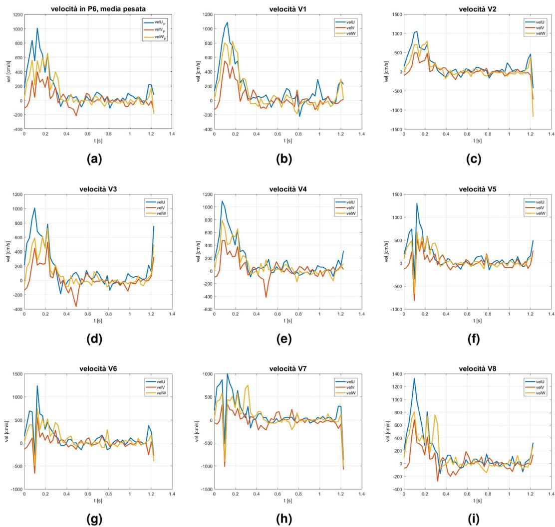
**Figura 4.15:** Velocità nei vertici  $V$  (b-i) e nel punto  $P$  (a) ottenuta come media pesata delle velocità nei vertici
