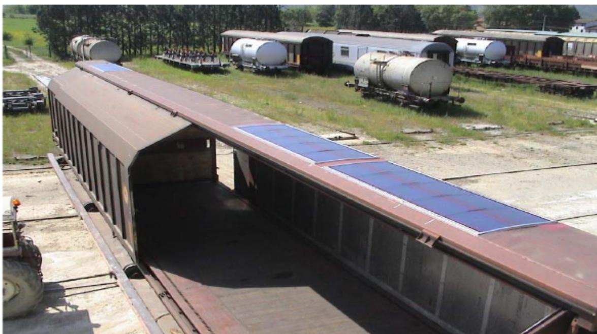
**Figura 2.2:** Prototipo di carro merci con pannello fotovoltaico nell'ambito del Progetto PVTRAIN - Photovoltaic Train di Trenitalia S.p.A., [3]
