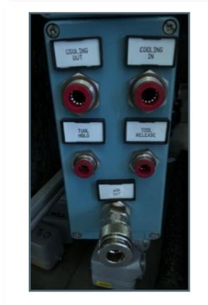
**Figura 5.15: Connettori idraulici e pneumatici**
