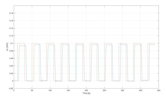
Figura 5.16. Risposta in termini di  $\Delta L$  [mm] del sistema di bloccaggio a "bottoncino"
