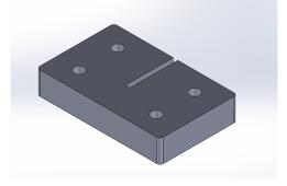
(c) Base per sensore di temperatura (CAD)
