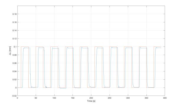
Figura 5.17. Risposta in termini di  $\Delta L$  [mm] del sistema di bloccaggio con piattine
