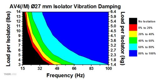
Figura 4.1. Carico-Frequenza per ciascuno smorzatore passivo (*Copyright 1999-2018 Thorlabs, Inc.*)
