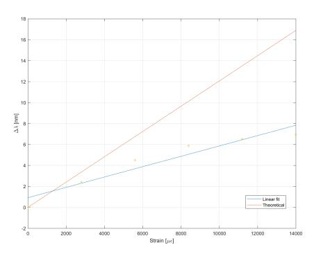
Figura 5.4. Curve teoriche e sperimentali per il sistema di bloccaggio con gomma dura e lunghezza della fibra a riposo  $L_0{=}53.59~\mathrm{mm}$
