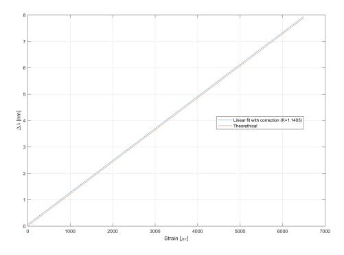
Figura 5.25. Confronto tra l'andamento teorico e quello sperimentale con fit lineare e coefficiente correttivo
