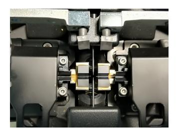
Figura 4.18. Posizionamento delle fibre
