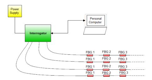
Figura 4.21. Schema di funzionamento dell'interrogatore
