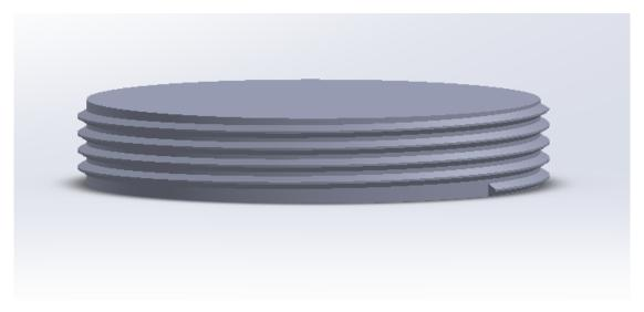
Figura 5.33. Realizzazione CAD di un possibile sistema di bloccaggio a superficie di aderenza maggiorata
