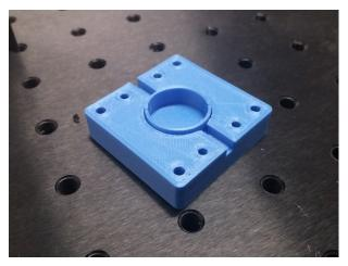
(a) Base da montare sul micromovimentatore
