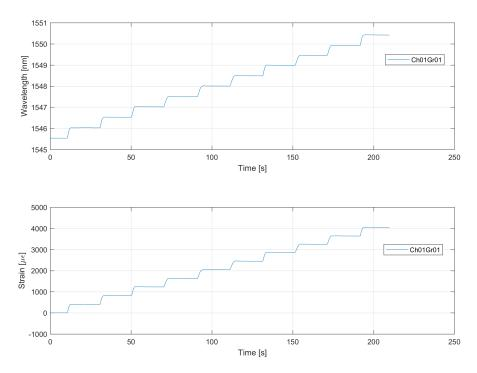
Figura 5.13. Test a step incrementali con sistema di bloccaggio con gomma morbida su linea lunga  $L_0{=}228.94~\mathrm{mm}$
