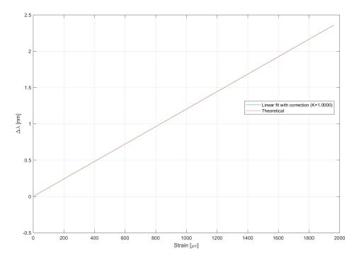
Figura 5.29. Confronto tra l'andamento teorico e quello sperimentale con fit lineare e coefficiente correttivo
