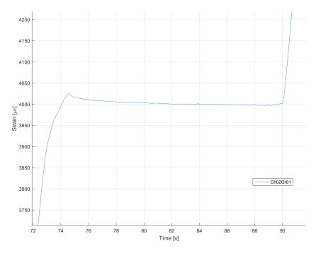
Figura 5.7. Dettaglio dello slittamento in termini di deformazione per la linea intermedia.
