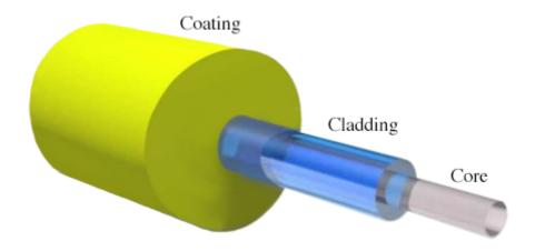
Figura 1.1. Esempio della struttura di una fibra ottica.
