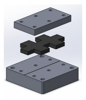
Figura 4.2. Sistema di bloccaggio da montare sul micromovimentatore (CAD)
