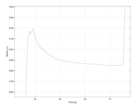
Figura 5.3. Dettaglio dello slittamento in termini di deformazione per la linea corta.
