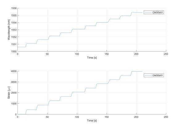
Figura 5.8. Risposta in termini di deformazione  $(\epsilon)$  e lunghezza d'onda  $(\lambda)$  per la linea corta.
