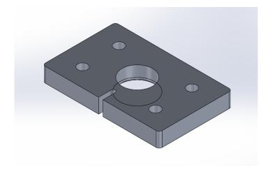
Figura 4.15. Base per cella *Peltier* con foro filettato M20 (CAD)
