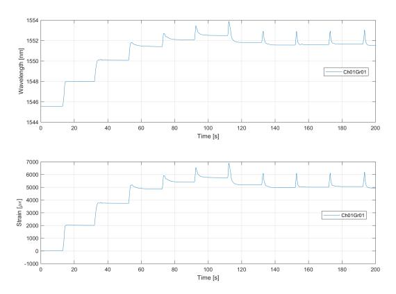
Figura 5.1. Risposta in termini di deformazione ( $\epsilon$ ) e lunghezza d'onda ( $\lambda$ ) per la linea corta.
