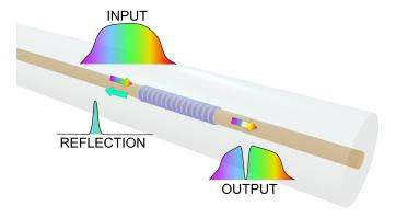
Figura 2.1. Funzionamento di un sensore a reticolo di Bragg
