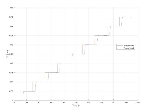
Figura 5.26. Confronto tra l'andamento teorico e quello sperimentale con carico a step incrementale
