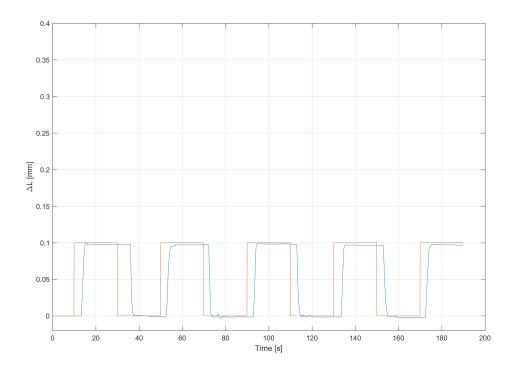
Figura 5.30. Test di ripetibilità con carico a step. Pre-carico di 0.30 mm
