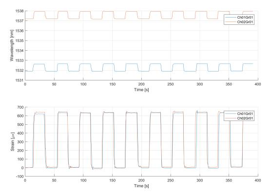
Figura 5.15. Confronto sulla risposta dei sensori utilizzando due differenti sistemi di bloccaggio.
