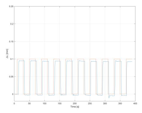
Figura 5.14. Test di ripetibilità su sistema di bloccaggio su linea lunga  $L_0=228.94$  mm e gomma morbida
