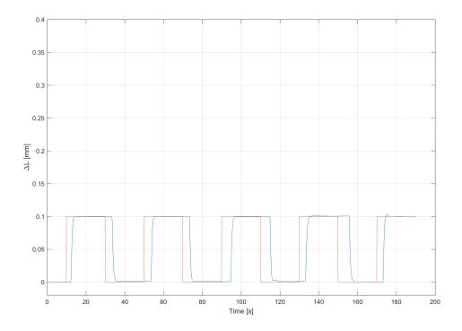
Figura 5.32. Test di ripetibilità con carico a step. Pre-carico di 0.10 mm
