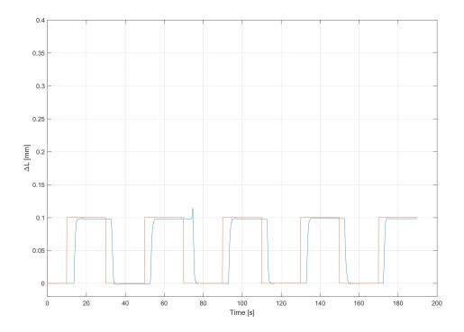
Figura 5.31. Test di ripetibilità con carico a step. Pre-carico di  $0.20~\mathrm{mm}$
