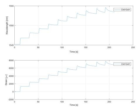
Figura 5.12. Test a step incrementali con sistema di bloccaggio con gomma morbida su linea corta  $L_0{=}58.59~\mathrm{mm}$
