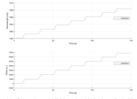
Figura 5.5. Risposta in termini di deformazione  $(\epsilon)$  e lunghezza d'onda  $(\lambda)$  per la linea intermedia.
