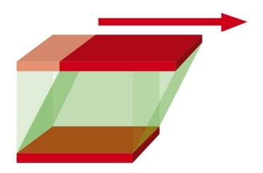
Figura 5.2. Deformazione a taglio dello strato di gomma.
