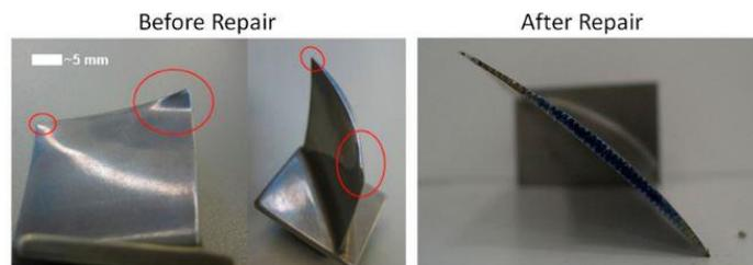
Figura 1.6 Riparazione di una palette di turbina con un sistema ibrido DED+CNC. [17]
