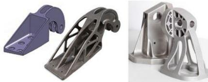
Figura 1.14 A320 nacelle hinge bracket, passaggio al processo additivo. [31]
