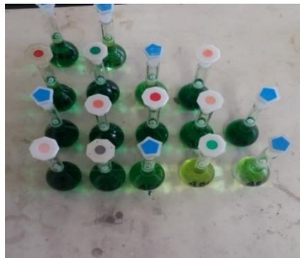
Figura 26: Preparazione dei campioni sottoposto al Test relativo alla determinazione dell'azoto ammoniacale  $NH_4^+$
