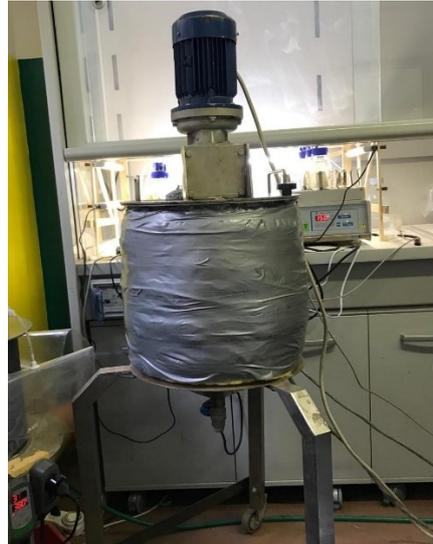
Figura 21: Reattore utilizzato per i pretrattamenti termo-alcalini sui fanghi di supero
