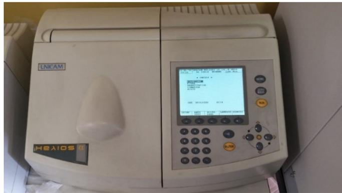
Figura 25: Strumentazione impiegata per la determinazione dell'azoto ammoniacale  $NH_4^+$
