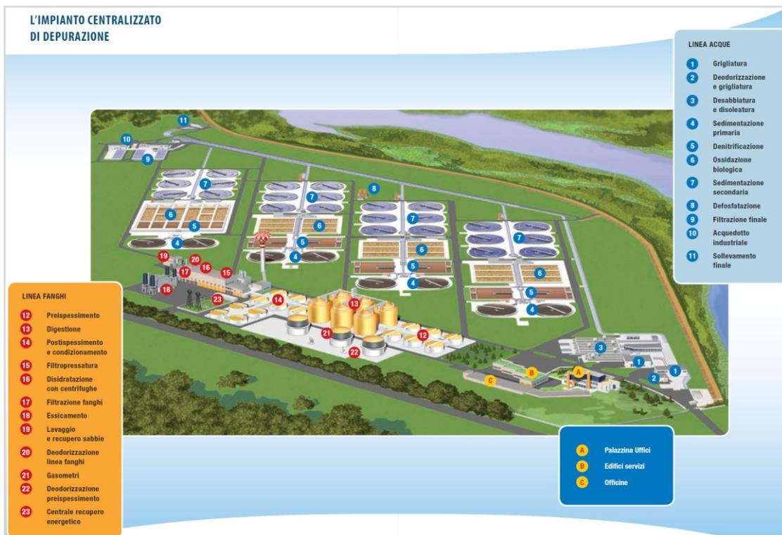
Figura 1: Schema generale dell’impianto di Castiglione Torinese – gruppo SMAT (SMAT G.S., 2015)
