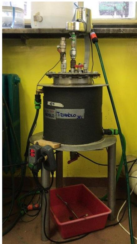
*Figura 34: Digestore semi-continuo utilizzato per la digestione anaerobica dei fanghi di supero pretrattati*
