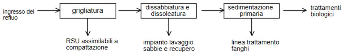
Figura 2: schematizzazione linea trattamenti primari
