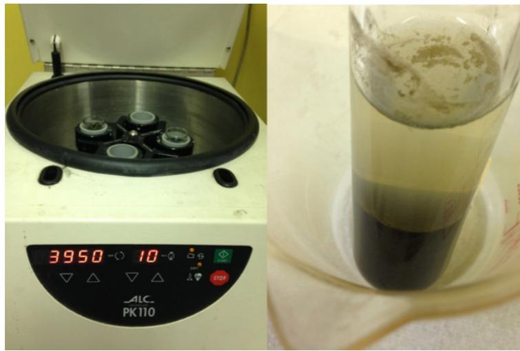
Figura 23: A sinistra: strumentazione utilizzata per la centrifugazione del campione; a destra: campione a seguito della centrifugazione, caratterizzato da una frazione solubile ed una frazione corpuscolare
