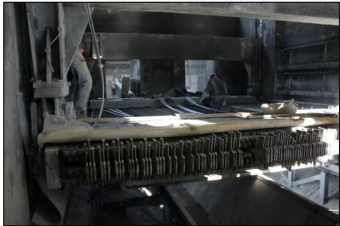
*Figura 5: da sinistra- graniglia abrasiva e telaio a torbida abrasiva*
