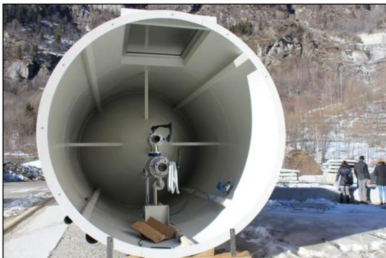
Figura 13: interno di una filtropressa
