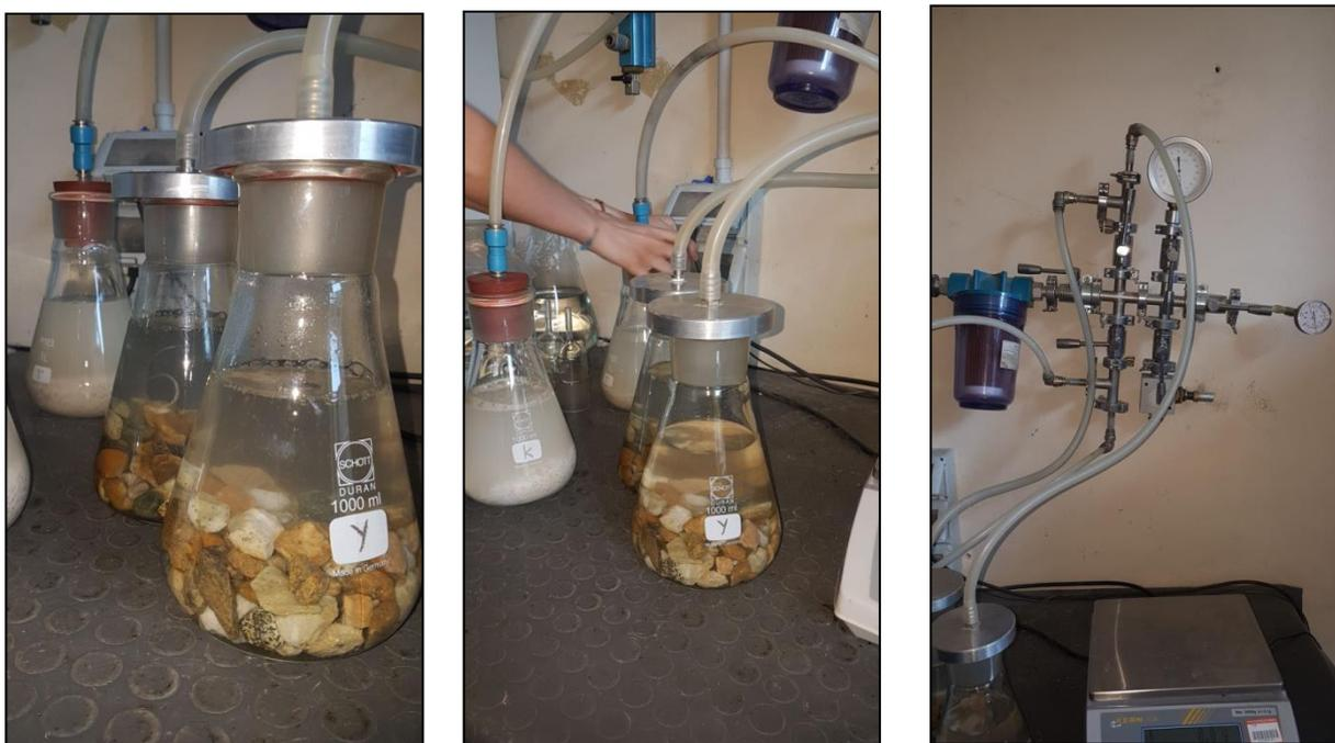
Figura 36: da sinistra: picnometri con all'interno quarzite oggetto di studio e materiale metamorfico. Sistema di pompa sottovuoto.
