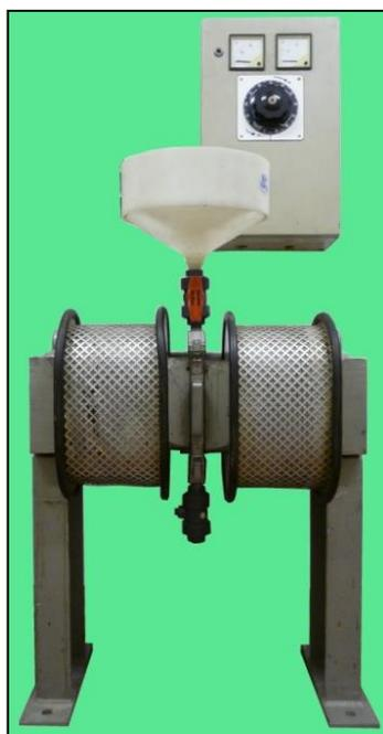
Figura 18: Separatore magnetico ad umido, a campo intenso, con dispositivo di separazione del tipo a filtro magnetico, casa costruttrice ERIEZ Magnetics.
