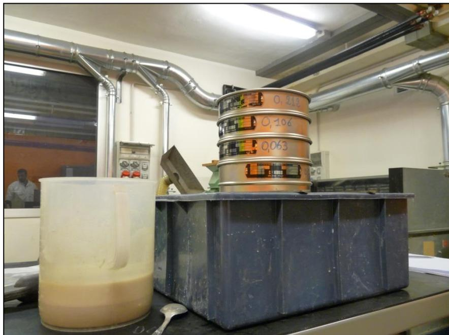
Figura 16: setacci per l'analisi granulometrica a umido dei fanghi di segazione
