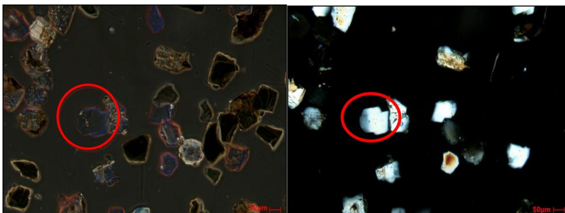
Figura 21: rappresentazione al microscopio ottico della frazione amagnetica G 0,075-0,106 mm in contrasto di fase a sinistra e polarizzata a destra 10X
