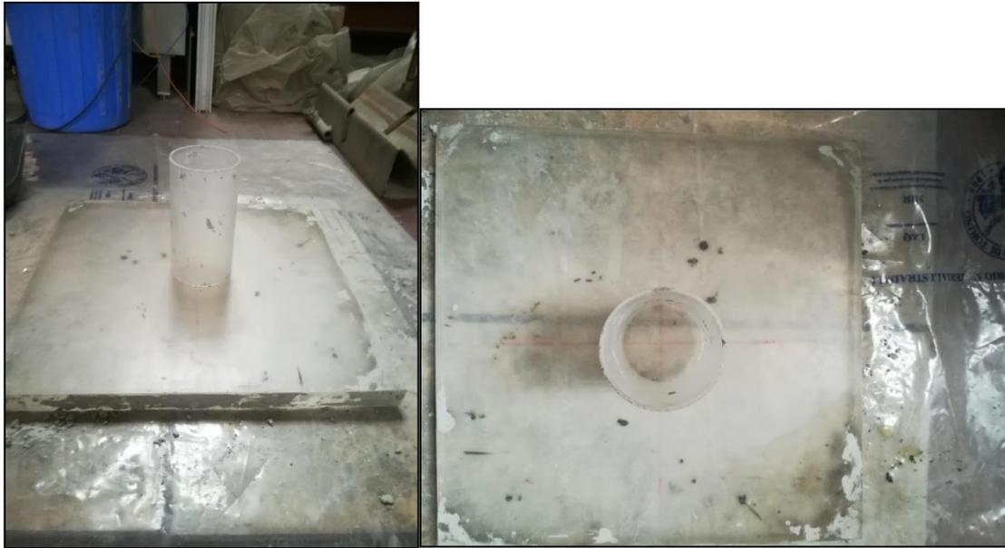
*Figura 42: strumenti per la prova di spandimento*
