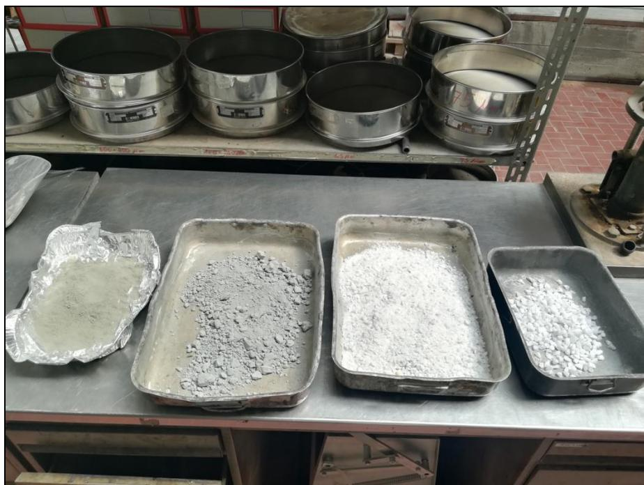
Figura 32: da sinistra: Cemento Portland, fango M, quarzite 0-8 mm, quarzite 8-16 mm
