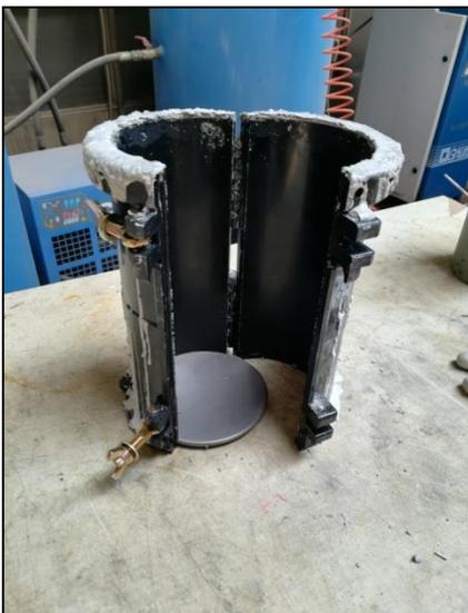
*Figura 43: stampo cilindrico di altezza 200 mm e diametro 100 mm*
