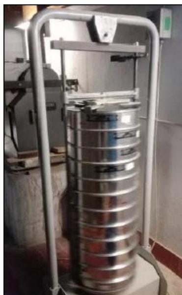
*Figura 34: colonna di setacci più pedana vibrante in laboratorio*
