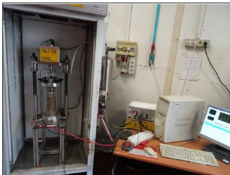
Figura 48: apparecchiatura della prova in cella triassiale a carico ripetuto
