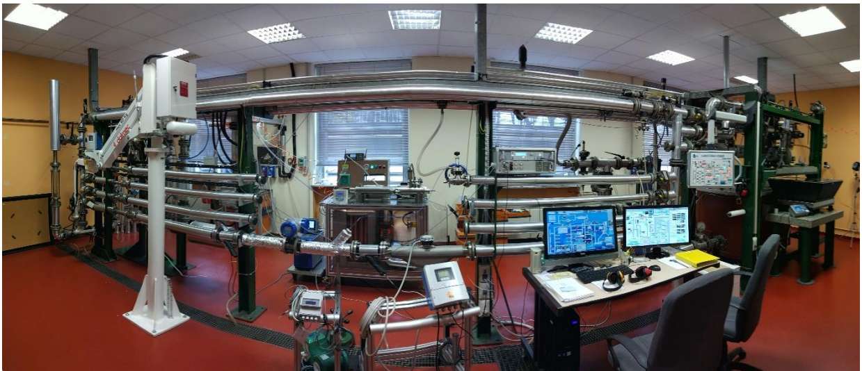
Figura 84: Impianto campione nazionale dell'INRIM per la misura di portata d'acqua ed energia termica
