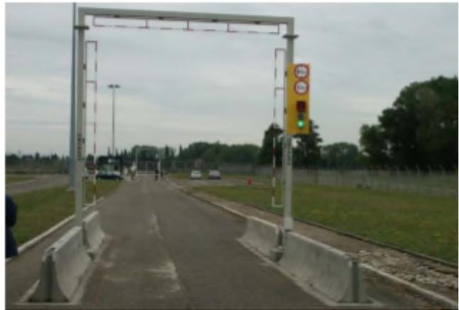
*Figura 6: Esempio di rivelatore "a portale" che effettua rivelazione anche dall'alto*
