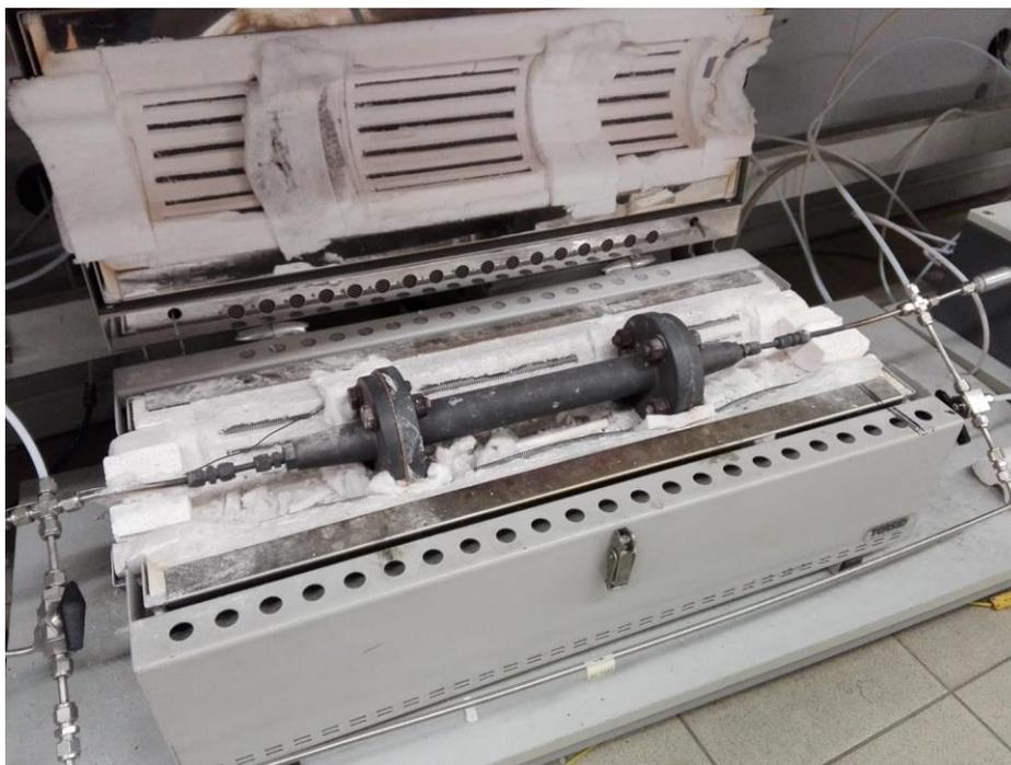
Figura 4.1 reattore e forno per test con monoliti
