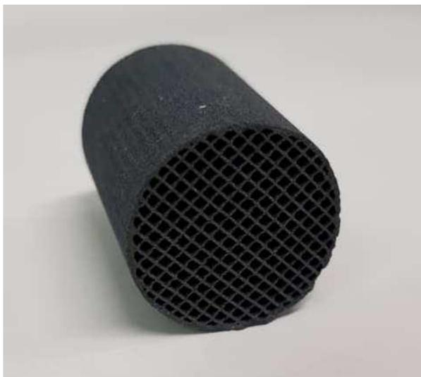
Figura 2.1 *monolita in carburo di silicio*
