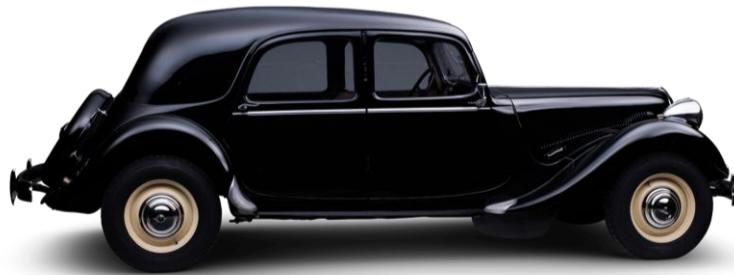
Figura 11: Citroën Type 7A (1934) - trazione anteriore, monoscocca, assetto aerodinamico, elevati costi di produzione
