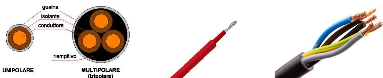
*Figura 10.1.2 Esempio di struttura di un cavo unipolare e multipolare*
