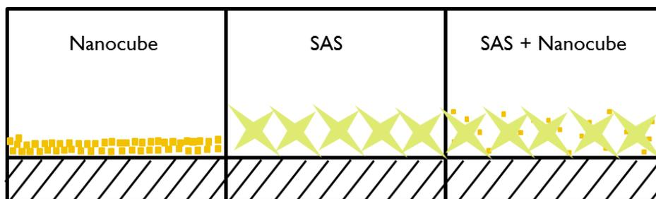
**Figura 4.31** - Esempio di coating multistrutturato ottenuto grazie alla presenza di SAS e nanocubi.
