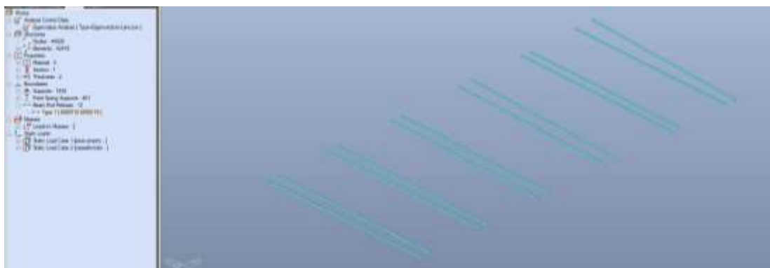
Figura 21 Modellazione delle “beam” delle capriate
