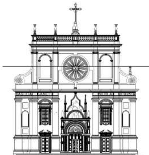
Figura 73 Rappresentazione del livello a cui è stato calcolato il cinematismo di collasso della sommità della facciata (rif. Tavole a cura dell'Università degli studi di Camerino - sede di Ascoli Piceno- Facoltà di Architettura, corso di Rilievo urbano e ambientale)
