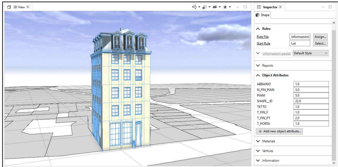
Figura 57 – Modellazione di un edificio dell'isolato, in particolare il numero civico 9 di rue du Mouton, contenuto nel file dei rilievi di Davioud denominato 528.jpg. Nella finestra inspector sulla destra dell'area di lavoro sono elencati gli attributi dell'oggetto selezionato, inseriti nell'indagine GIS precedente.
