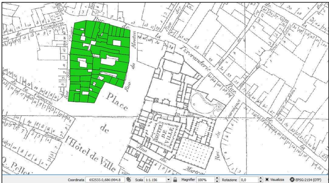
Figura 24 – Dato vettoriale 'Bati' sul programma QGIS. Vettore di tipo poligono, ogni elemento corrisponde ad un edificio rilevato. Di base, l’Atlas Jacoubet.
