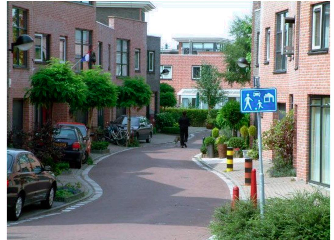
Figura 14: Tipico *woonerf* segnalato dal segnale blu sulla sinistra, le macchine possono entrarvi solo come ospiti, tenendo dunque una velocità non maggiore dei 15km/h
