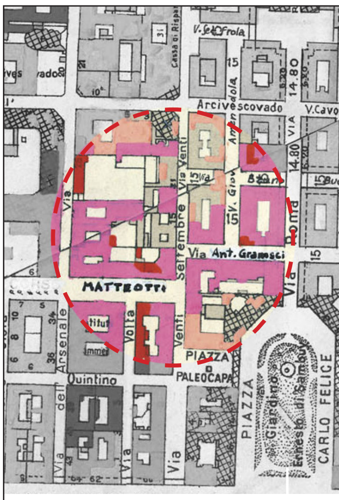
Fig. 50 Dettaglio della mappa redatta dai Vigili del Fuoco nel 1946 indicante i danni arrecati agli stabili dai bombardamenti. Con l'arancione sono indicati i danni lievi, con il fucsia i danni gravi e con il rosso quelli gravissimi. Nel cerchio rosso è evidenziato il lotto compreso tra corso Matteotti e via XX Settembre. (ASCT, Tipi e disegni, 68.1.2)
