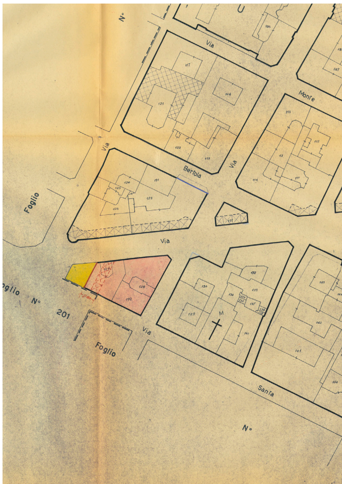
Fig. 61 Dettaglio della tavola di progetto inserita nei piani di ricostruzione del 22 ottobre 1949 . In rosso è rappresentato il progetto per il nuovo grattacielo della Spina di piazza Solferino, mentre in giallo l'arretramento di tredici metri previsto su piazza Solferino. Con il tratteggio rosso è invece indicata la galleria pedonale. (ASCT, Atti municipali, Verballi C.C. , 1949, seduta 22 ottobre 1949, par. 27, all. n. 1, foglio 199.)
