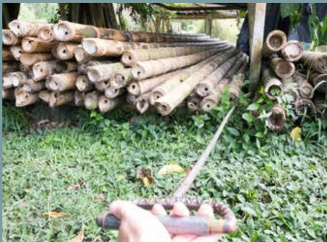
[5.0] Strumento utilizzato per la foratura dei nodi
