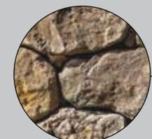
La pietra grossolanamente lavorata si propone di utilizzarla nel letto dei fiumi come base di appoggio della struttura dei canali, in quanto resistente e a basso rilascio di detriti; gli stessi spesso si accumulano in prossimità dei ponti, limitando e bloccando lo scorrimento delle acque e generando fuoriuscite ed allagamenti.
